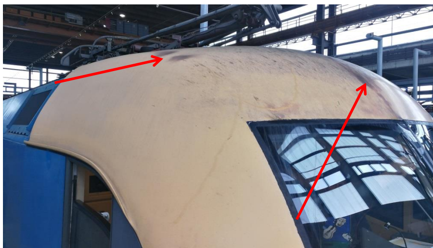
4. ábra: munkavezeték érintkezési nyomai
