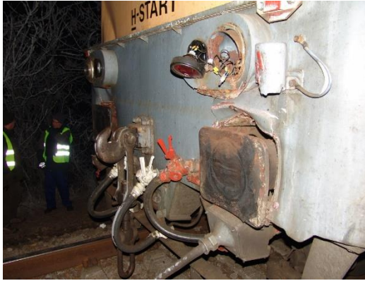
13. ábra: A 616 sz. vonat mozdonyának rongálódásai
