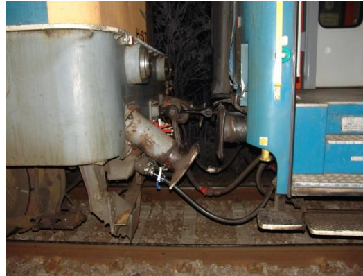
13. ábra: A 616 sz. vonat mozdonyának rongálódásai
