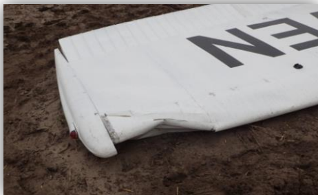
3. ábra: A szárny-belépőél sérülése
