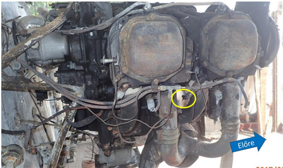
19. ábra: a boxer motor jobb oldali hengerei és a kipufogó rendszere
