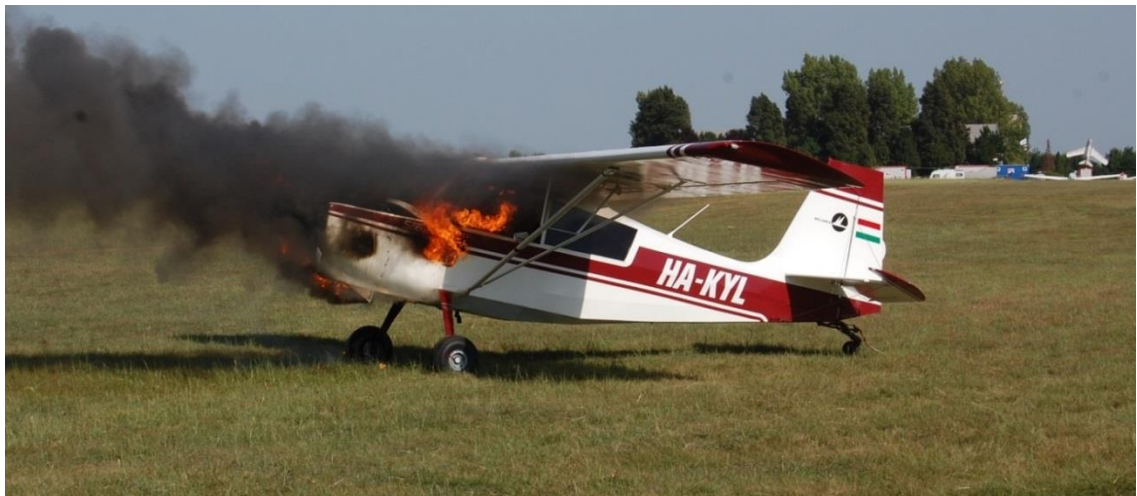
5. ábra: a tűz terjedése az üzemanyagcső mentén a szárny üzemanyag tartály irányába
