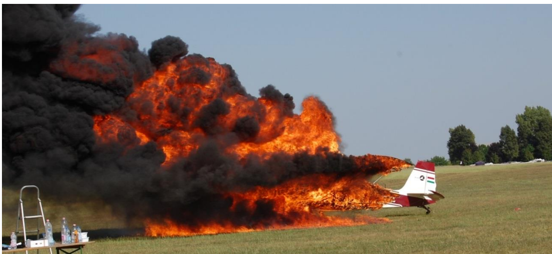
7. ábra: az üzemanyag tartályban lévő üzemanyag a földre kifolyt, majd ott szétterült
