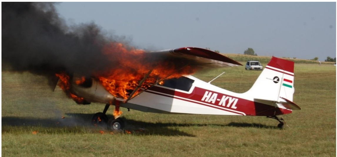
6. ábra: az üzemanyag tartály kiolvadt, az üzemanyag a szárny alsó felszínén végigfolyt
