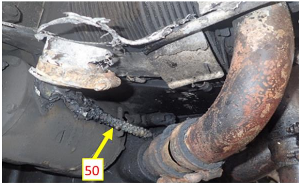
16. ábra: az 50-es kábel önindító felőli vége
