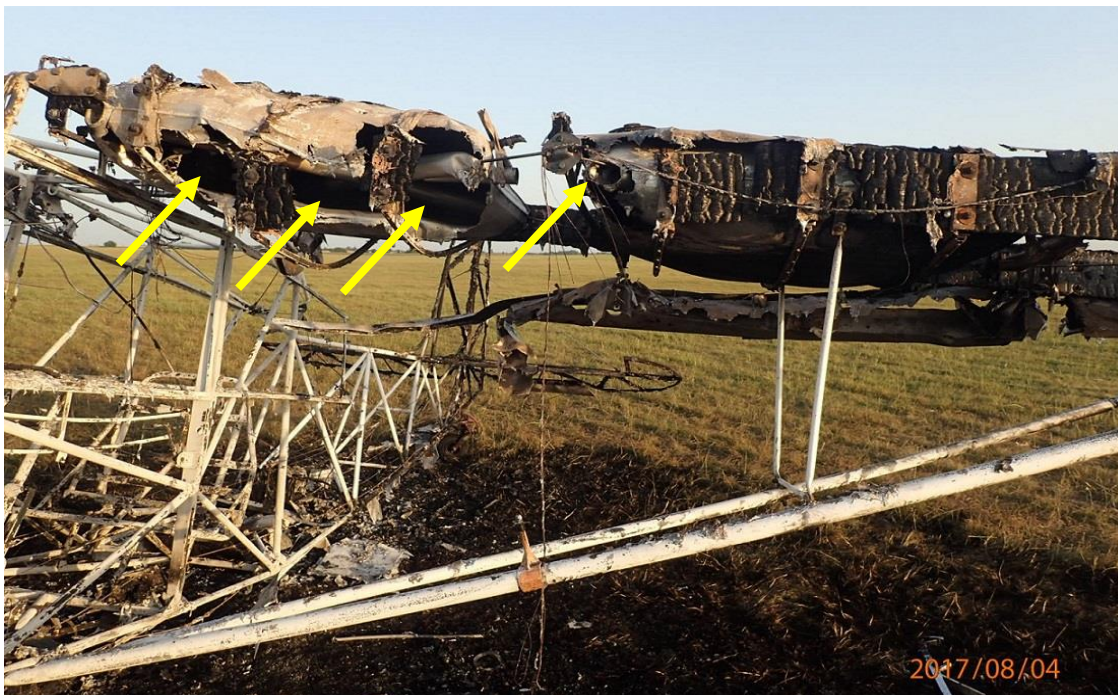
15. ábra: a megolvadt üzemanyag tartály
