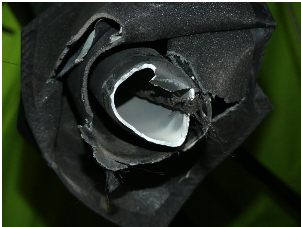
4. ábra: A függőcső, és annak törési felülete.
