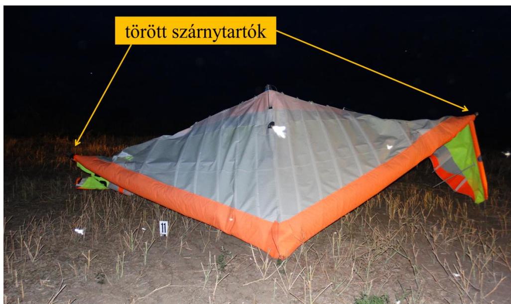
5. ábra: A törött szárnytartók.
