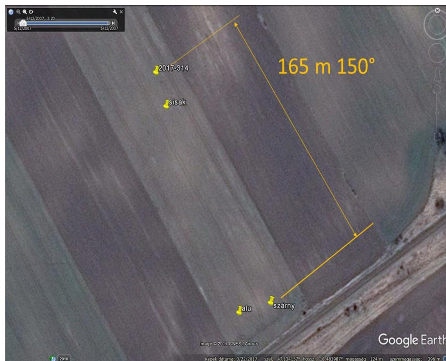
6. ábra: A sárkányrepülő részeinek elhelyezkedése.
