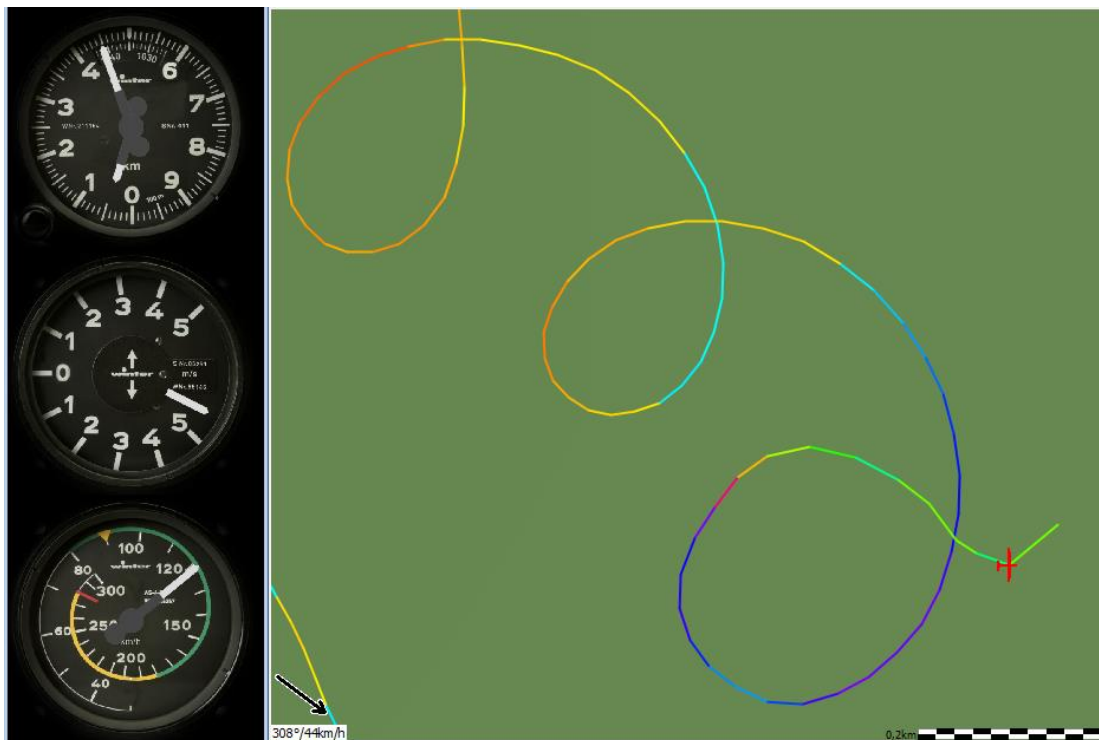
1/g. ábra: (-5. másodperc) magasságvesztés 50 m/s, körözés iránya megfordul a bal oldali szárny – feltehető – letörése után, talaj feletti magasság 320 méter.
