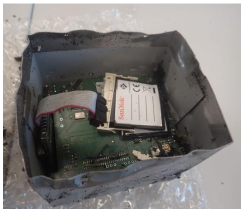
11. ábra: LX8000 navigációs berendezés és a benne talált sérült memória kártyák
