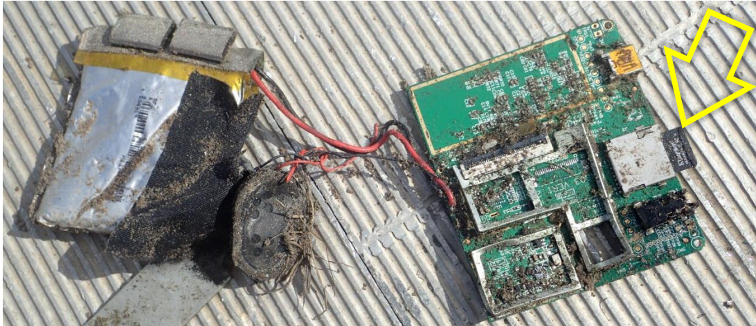
12. ábra: a pótszemlén megtalált sérült Colibri II berendezés a működőképes SD memória kártyával
