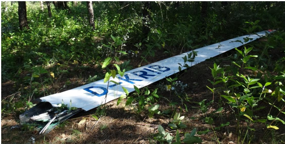
9. ábra: a repülés közben leszakadt bal oldali szárny
