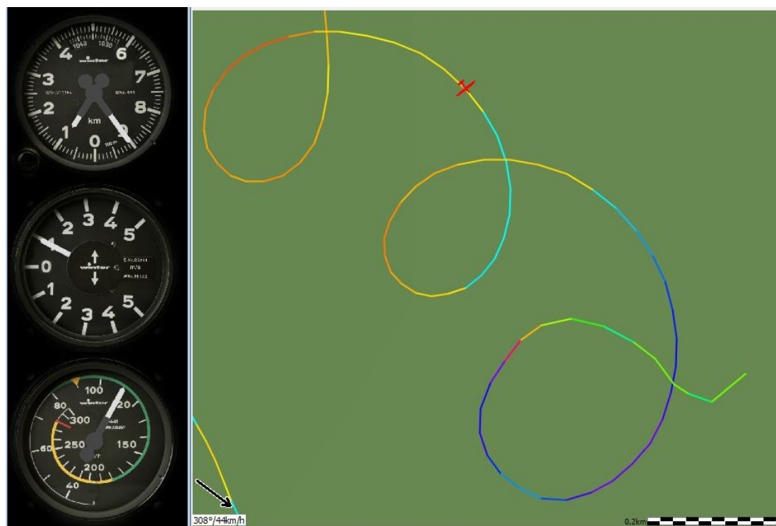
1/b ábra: (-63. másodperc) az első kör lerepülése, 80 méter emelkedés után
