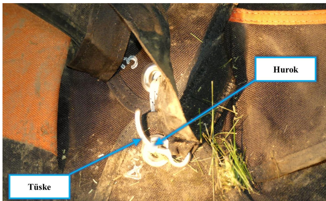
6. ábra: a főejtőernyő tokjának zárása
