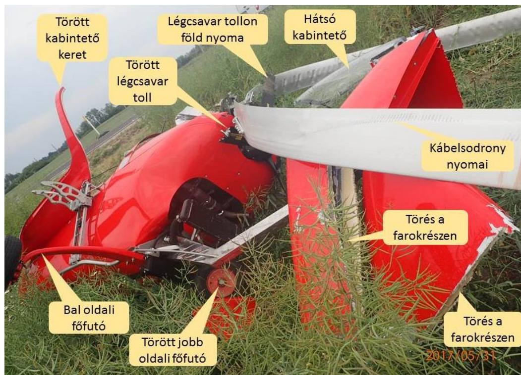
11. ábra: a nyugalomba kerülést követően az autogiron látható sérülések
