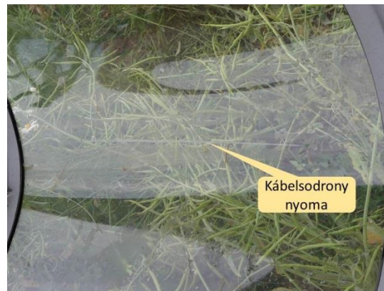
14. ábra: az elülső kabintető sérülése
