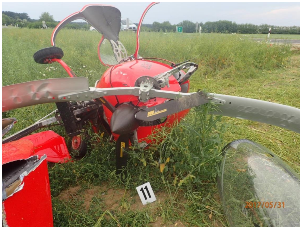
10. ábra: a motor légsavarjának sérülései
