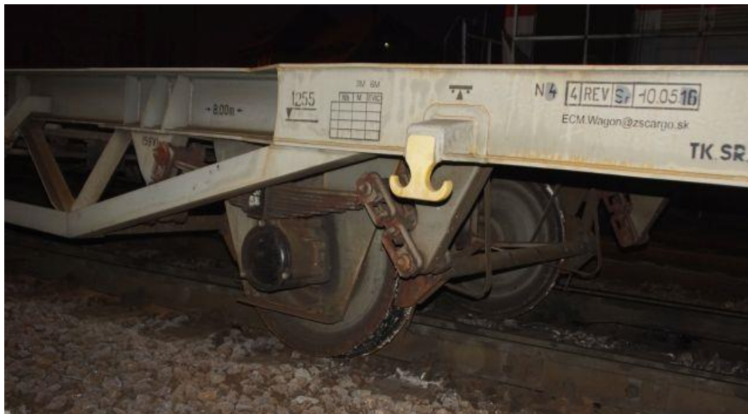
10. ábra: a kisiklott kerékpár
