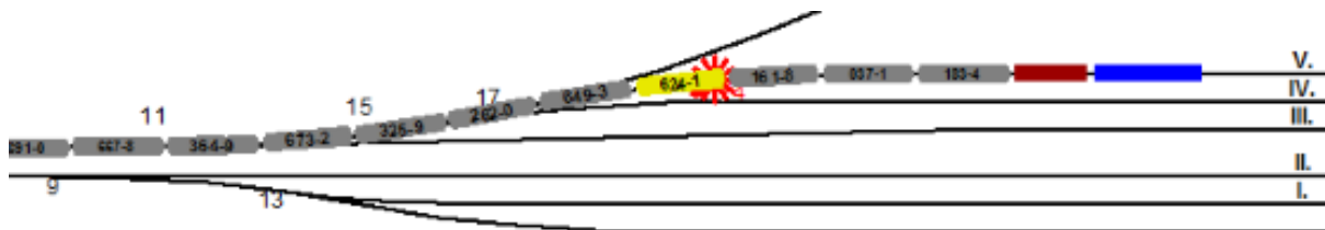
18. ábra: a 624-1 psz. kocsi kisiklásának pillanata (ez, és a következő hasonló ábrák teljes, összehasonlítható méretben a mellékletben)
