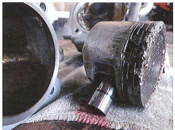
2. ábra: A sérült dugattyú
