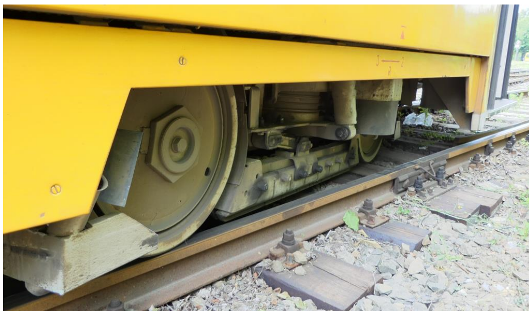
11. ábra: a júliusban kisiklott jármű siklott forgóváza
