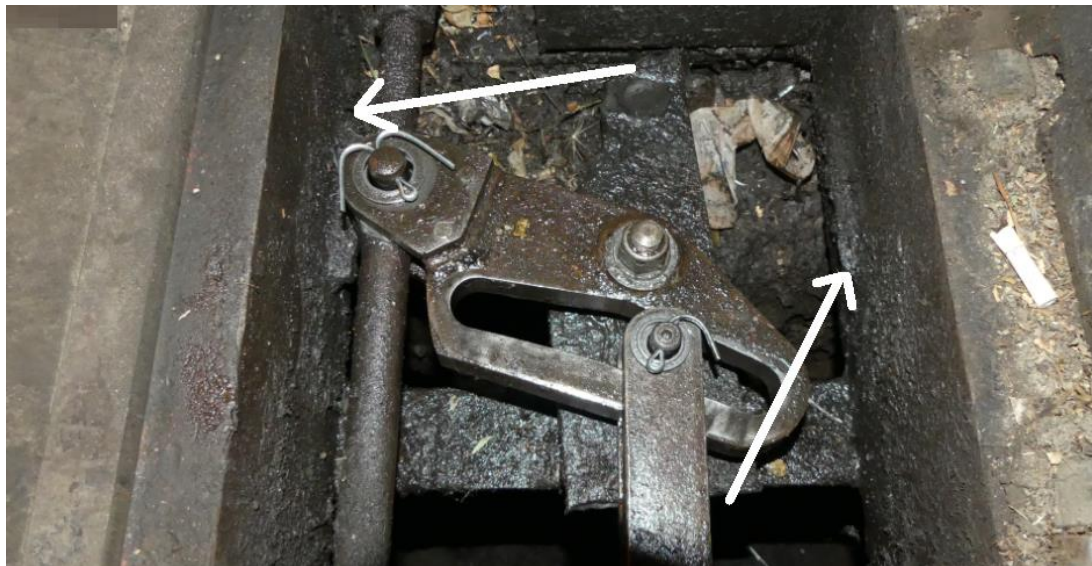
13. ábra: A letört és keresztbefordult kulisszatartó lemez (a nyilak a törött felületeket jelölik)
