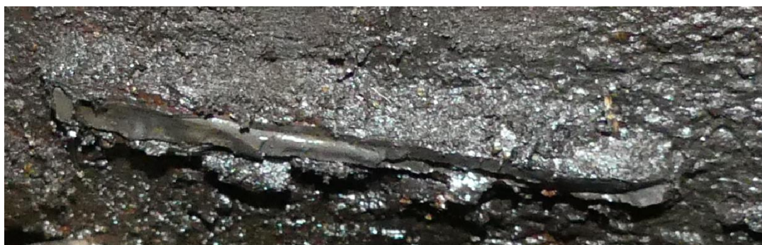
5. ábra: kulisszatartó lemez fáradásos törése
