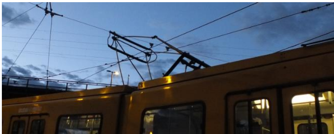
4. ábra: A beakadt és eltörött áramszedő
