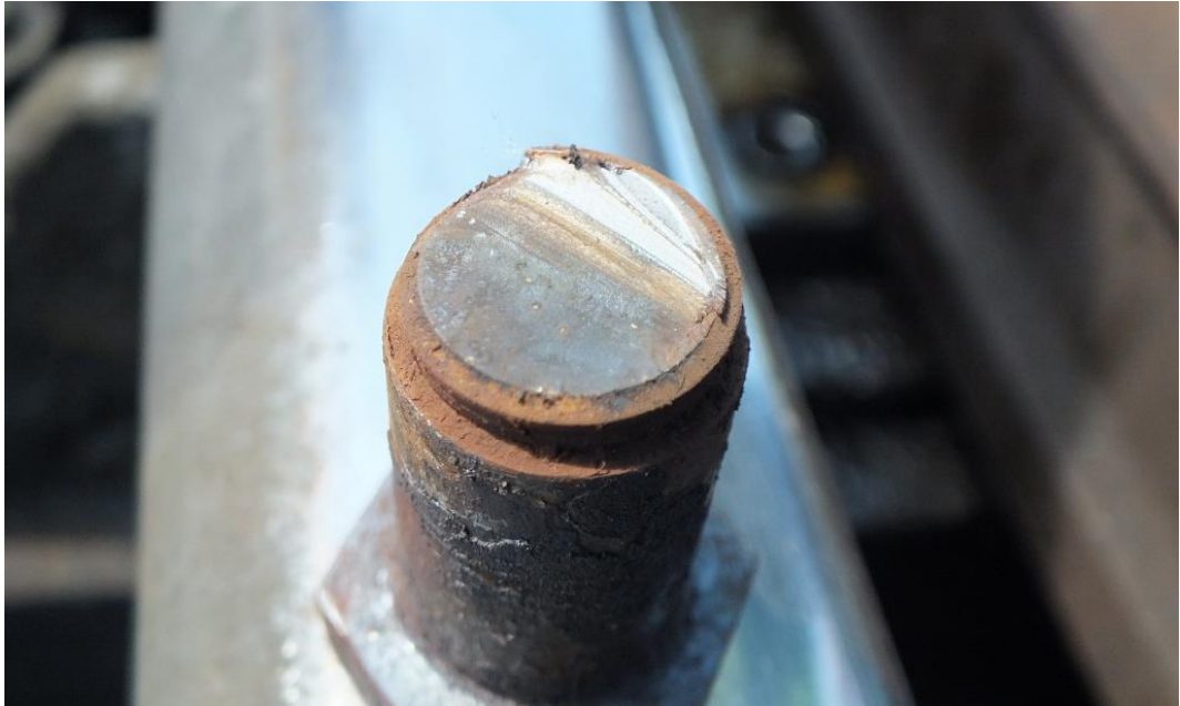
7. ábra: a csavar fáradásos törési felülete
