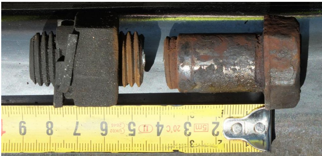
6. ábra: a törött csavar darabjai
