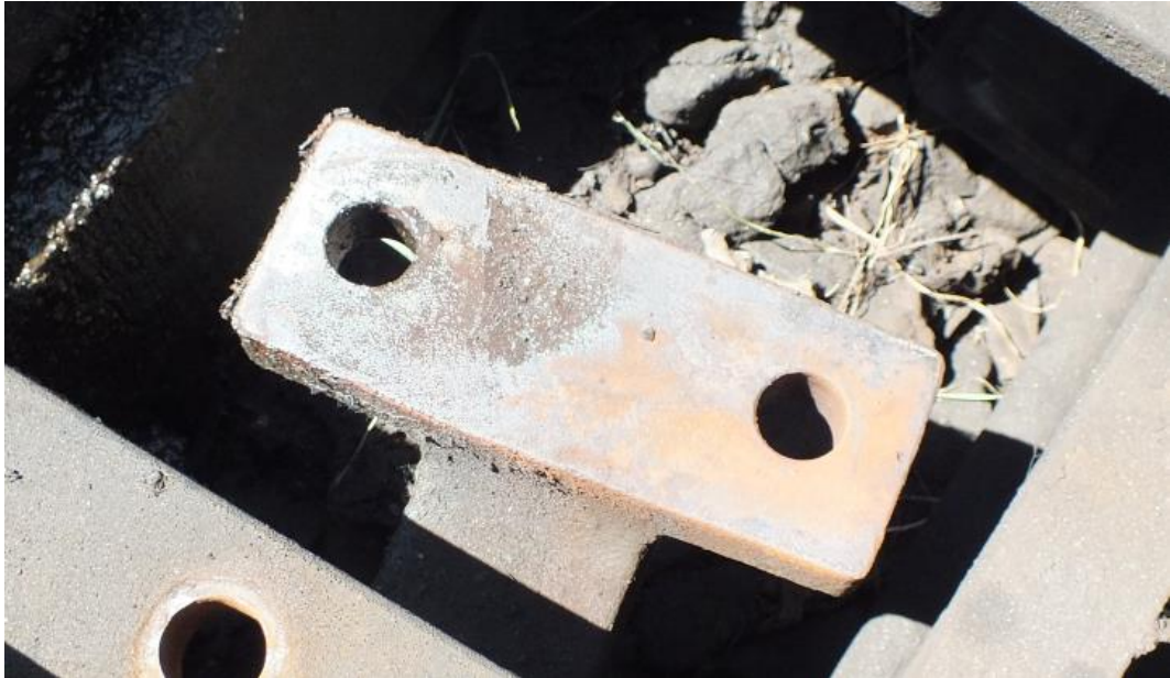
10. ábra: a csúcssínfül felülete a kitörött csavar helye mellett rozsdaporos, a széleken fényes
