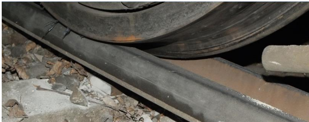
3. ábra: kisiklott jármű kereke az oldalára borult sínszálon
