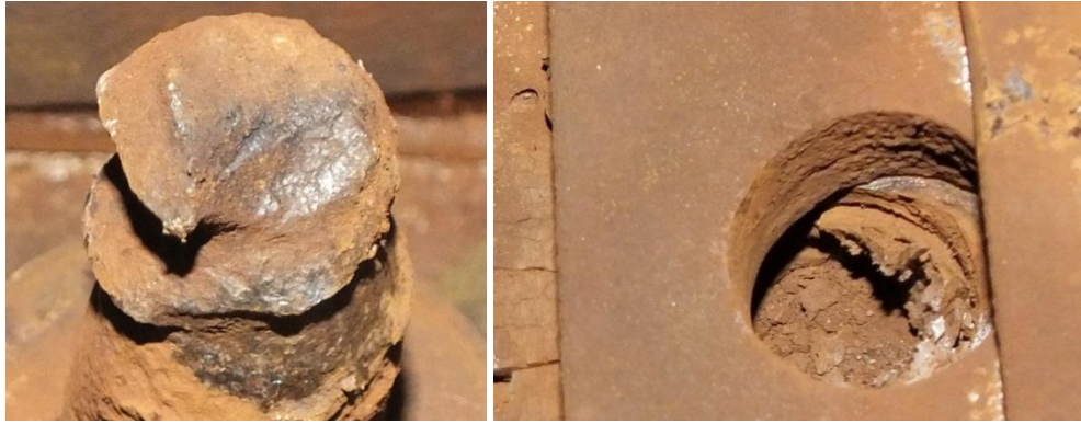
6. ábra: Egy csavar törési felülete, és egy kitört csavar helye
