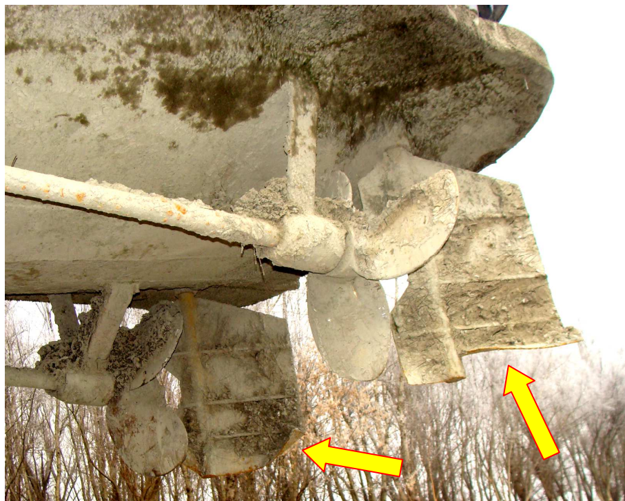
6. ábra: A kormánylapátok sérülései
