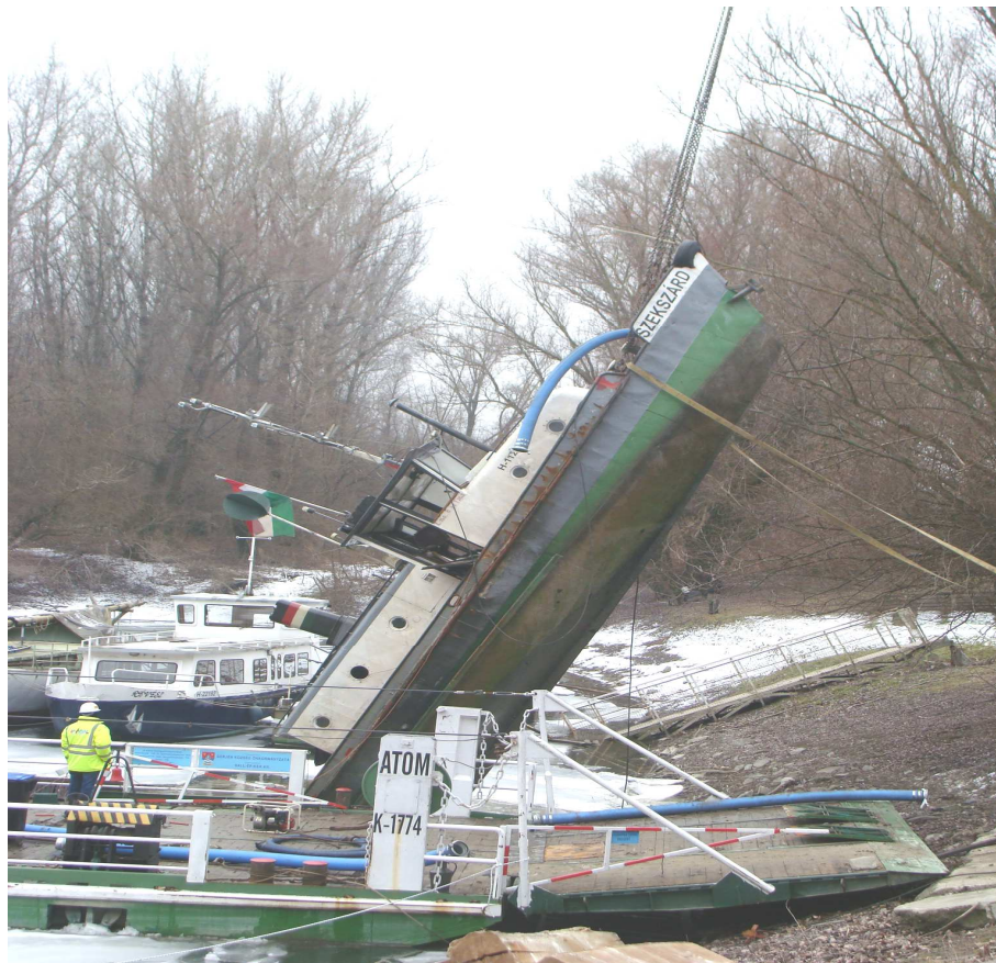
5. ábra: Az elsüllyedt kishajó kiemelése
