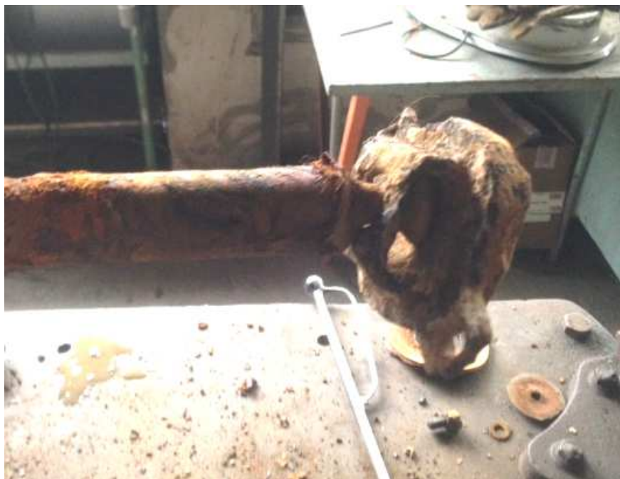
10. ábra: Az elhasználódott szeleptányér (Fotó: a kishajó javítását végző szervezet)
