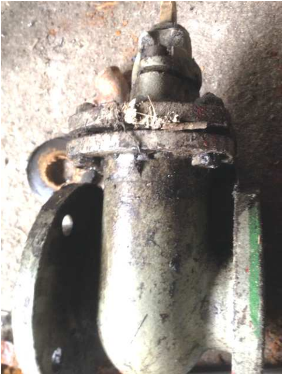
11. ábra: A tolóár kiszertelt állapotban, kétoldalt a peremes csőkötések (Fotó: a kishajó javítását végző szervezet)
