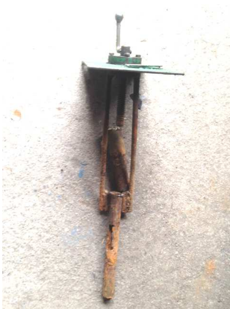
9. ábra: Az elzárószelep felső része, már leszerelt szeleptányérral (Fotó: a kishajó javítását végző szervezet)
