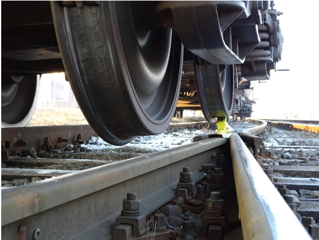
3. ábra: az elakadt saru egy kiemelkedett kerékkel
