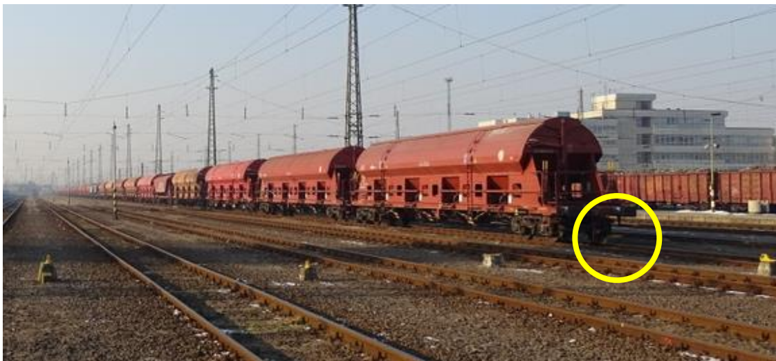
6. ábra: egy álló szerelvény az állomáson: rögzítősar csak a képen látható, végpont felőli végén van
