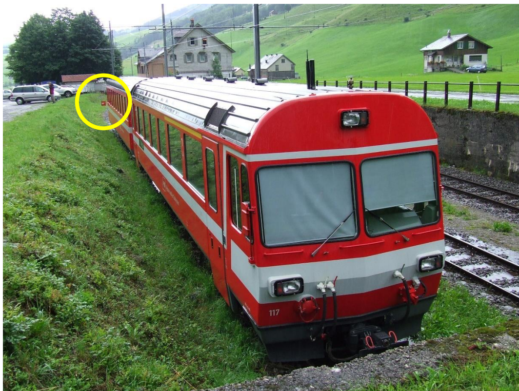
9. ábra: a sarura figyelmeztető jel onnan is jól látható, ahonnan a saru nem
