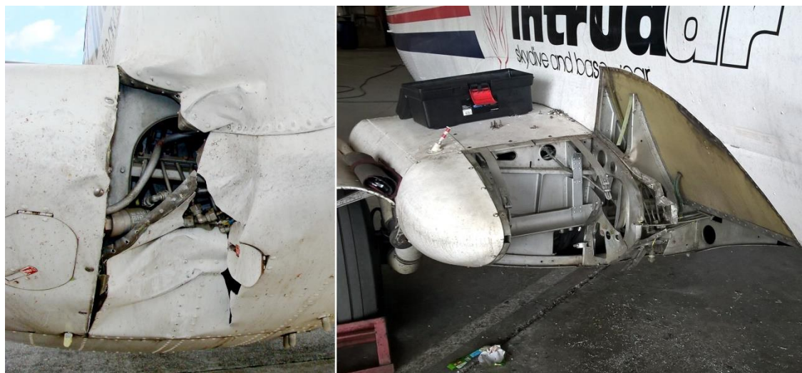
5. ábra jobb oldali futómű-gondola burkolat sérülten és javításhoz lebontva
