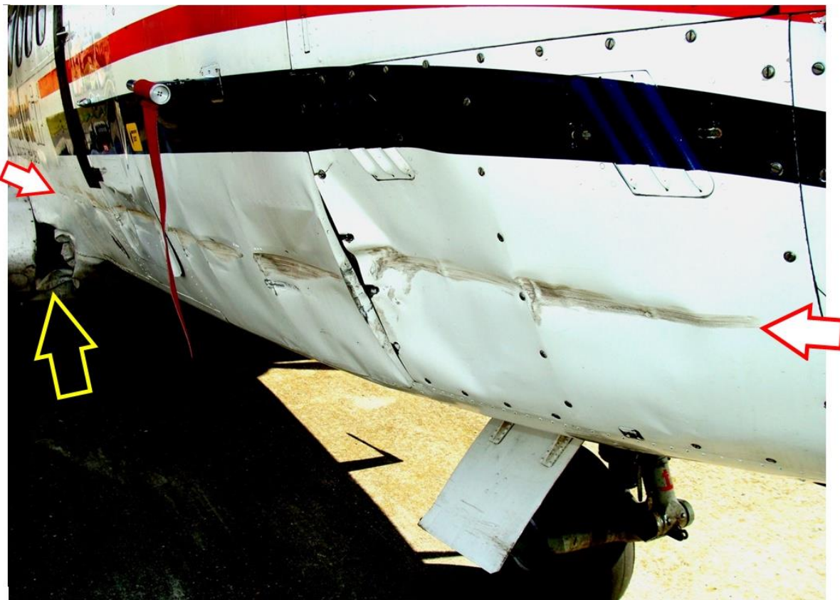
4. ábra a kerítésoszlop által okozott sérülések a törzs jobb oldalán
