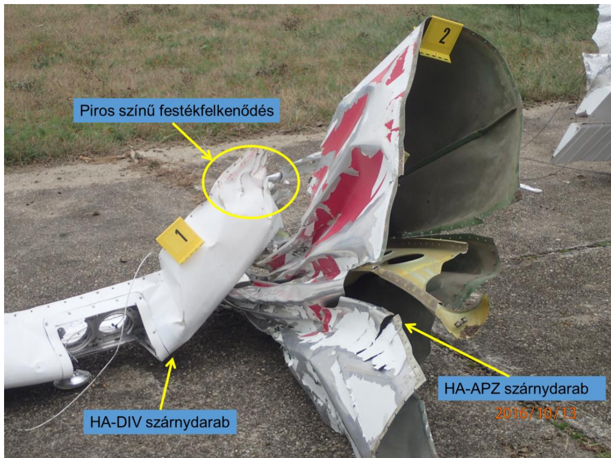
12. ábra: a légi járművek (1: HA-DIV, 2: HA-APZ) bal szárnyán lévő sérülések összeillesztése
