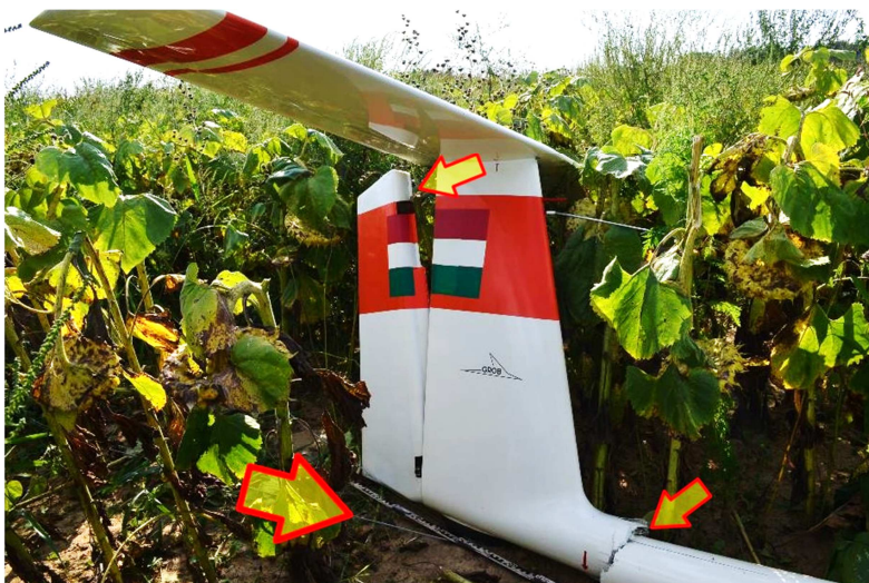
8. ábra: a farok rész a beakadt csörlőkötéllal és a sérülésekkel (KBSZ)
