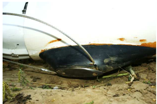
4. ábra: a farokcsúszóba akadt kötéll (KBSZ)
