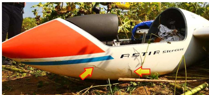
9. ábra: a törzs mellső részének sérülései (KBSZ)
