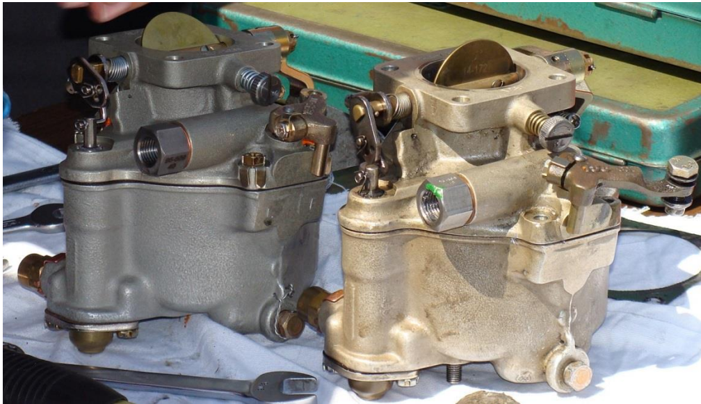
4. ábra: a meghibásodott és a próba során felépítésre került porlasztók
