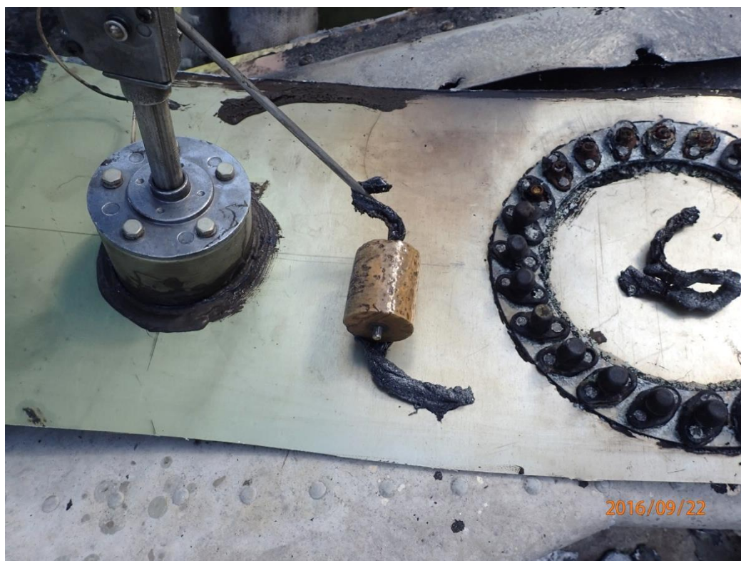
17. ábra a benzinszint mérő jeladó úszójára a felvált, ragacsos tömítőanyag rátekeredett
