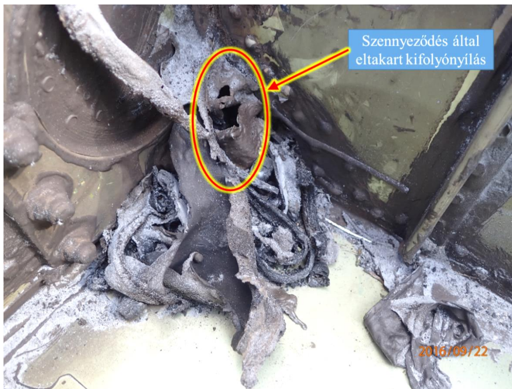
16. ábra az egyik szárny tüzelőanyag tartályában talált anyagmaradványok
