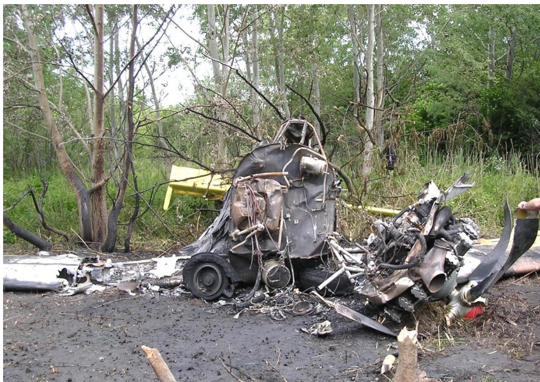
6. ábra az ütközés következtében leszakadt motor
