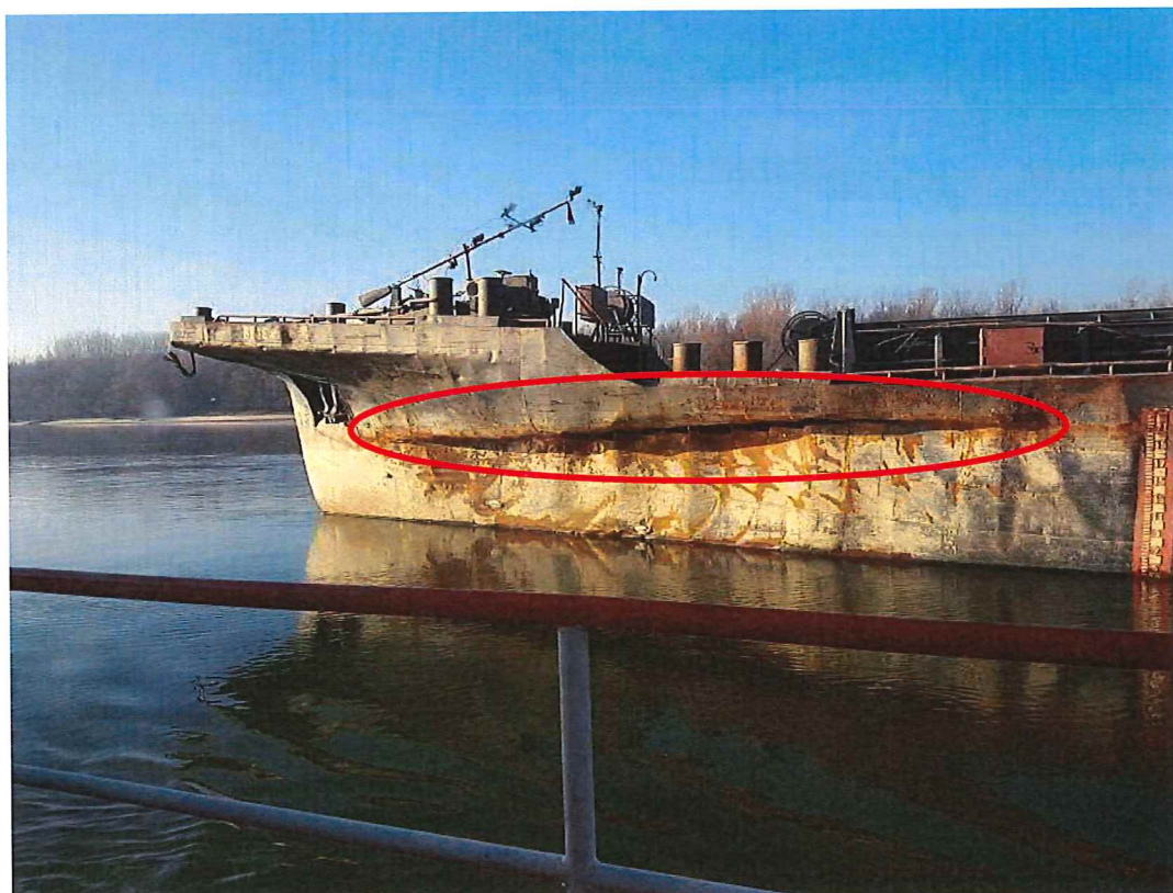
7. ábra: A repedés oldalnézetben (Fotó: Üzemeltető képviselője)
