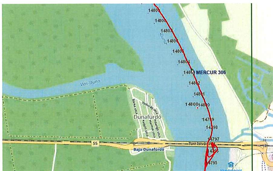
14. ábra: A Mercur 306 tolóhajó és tolatmánya útja a híd megközelítése során
