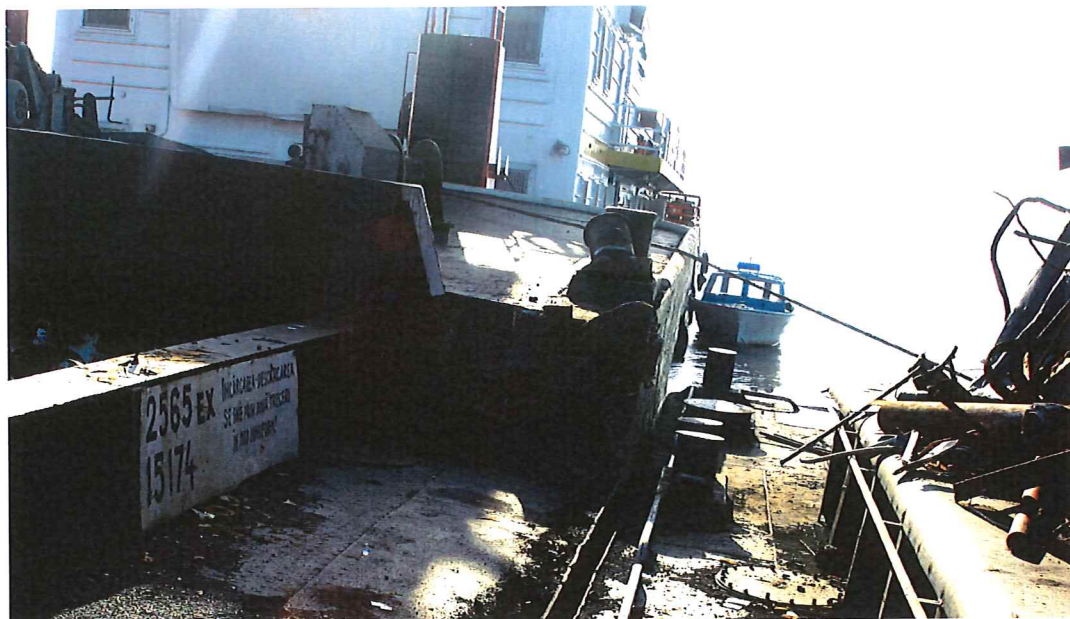
12. ábra: Kiszakadt bak és lemezsérülés a 2565 számú bárka bal oldalán hátul
