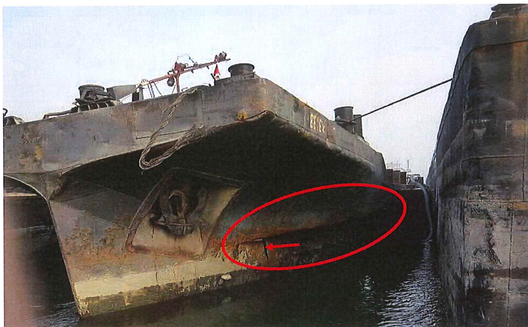
8. ábra: A felhasadt lemezelés szemből, látható a függőleges repedés is (Fotó: Üzemeltető képviselője)
