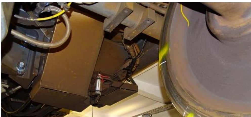
13. ábra Csőkamera elhelyezése a forgóvázon
