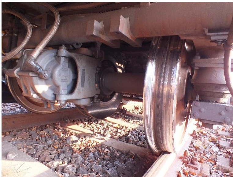
18. ábra: Foltosodás a 467 psz. T kocsí menetirány szerinti első tengelyén (a helyszíni szemle során készült felvétel)
