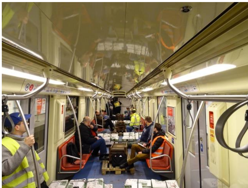
14. ábra: A műterhelés elhelyezése a szerelvényen
