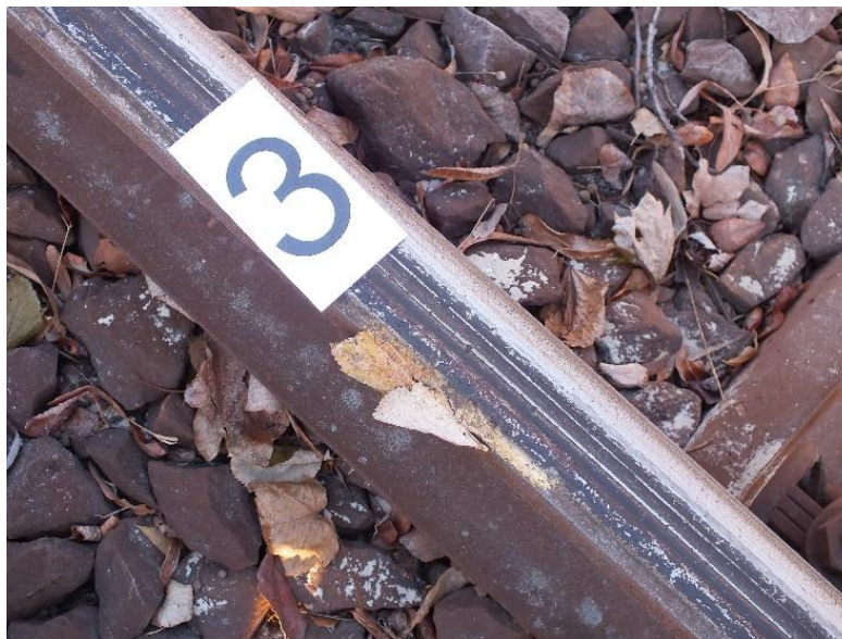
17. ábra: Kerekek által szétpréselt falevél a bal vágány jobb sínszálán (a helyszíni szemle során készült felvétel)
