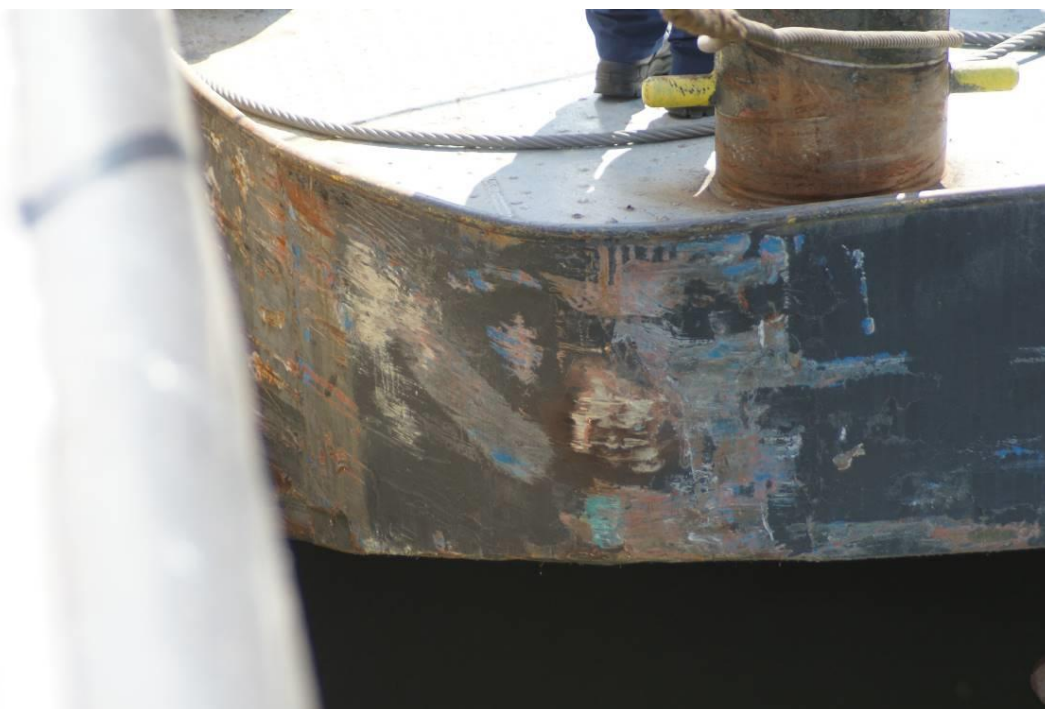
8. ábra: A „DIT Tank 58” bárka jobb első sarkán keletkezett sérülések
