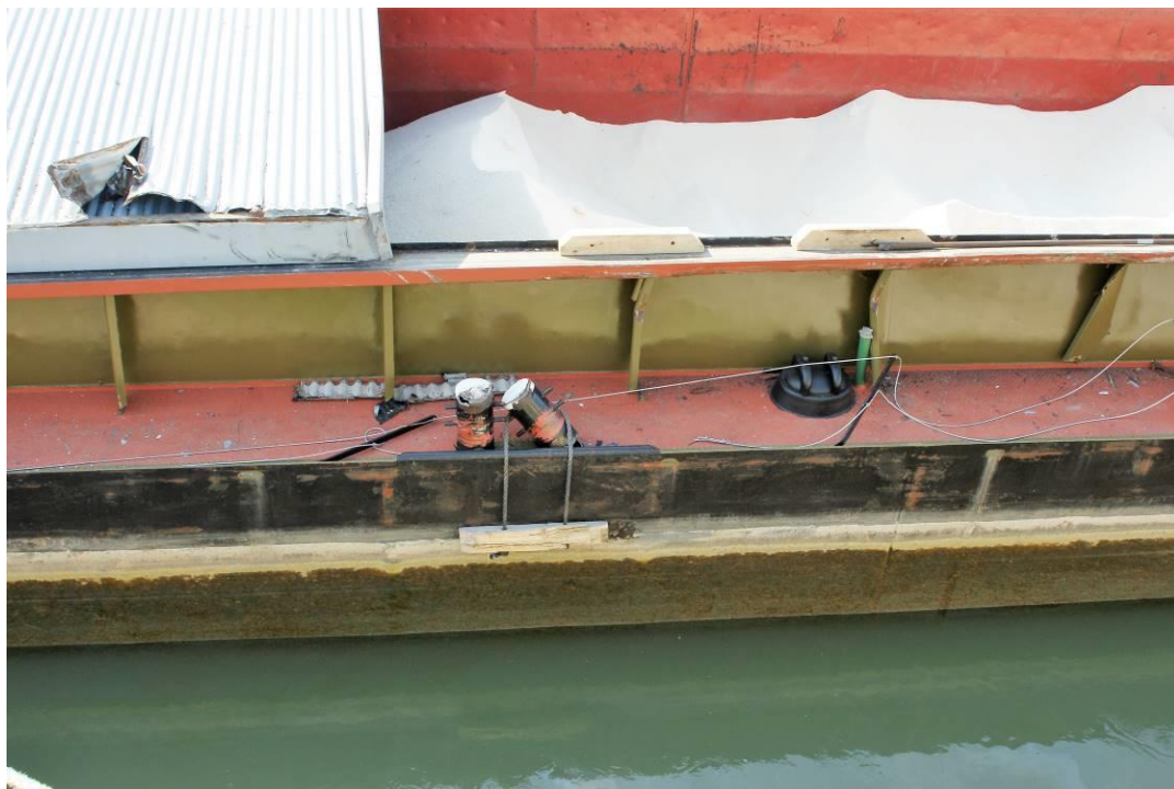
7. ábra: A „Murgtal” ms hátsó vágató bakjánál keletkezett sérülések
