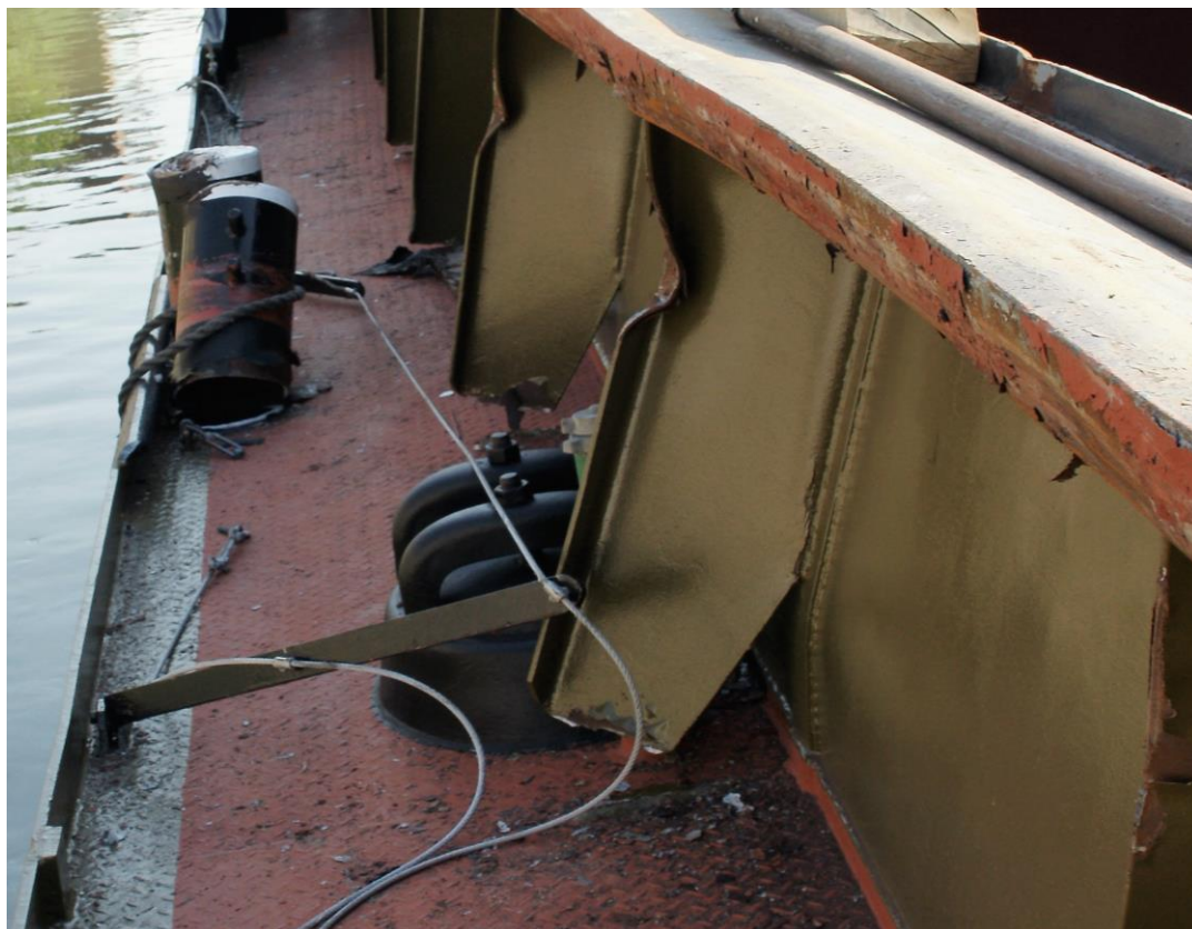
6. ábra: A „Murgtal” ms jobb hátsó harmadánál keletkezett sérülések
