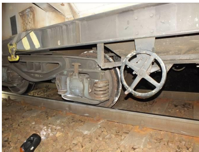
3. ábra: A kisklott forgóváz
