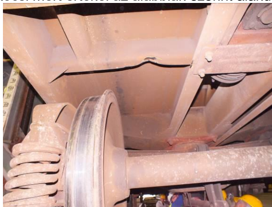
6. ábra: A kiélesedett kerék (siklott tengely jobb oldali kerék)
