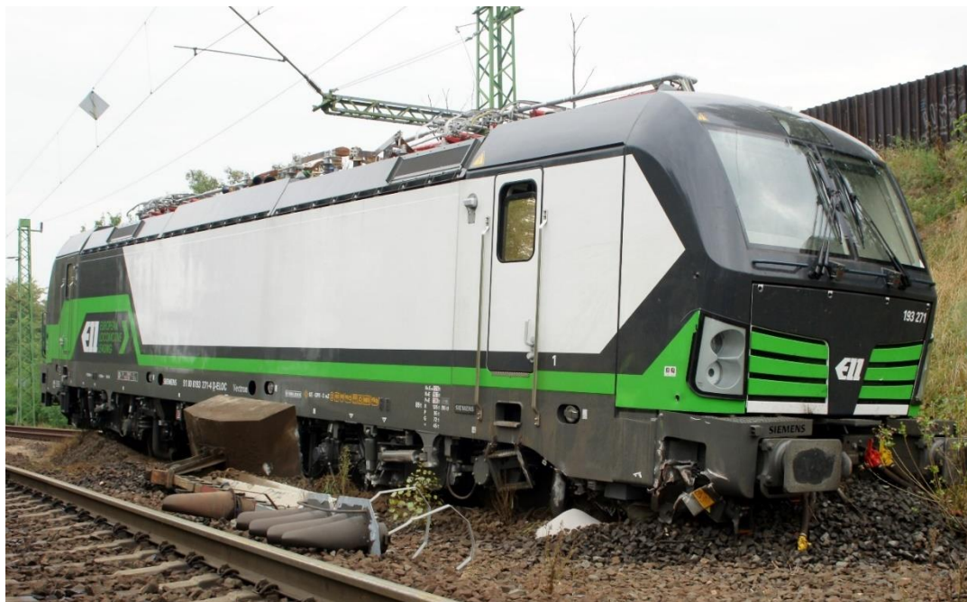
3. ábra A mozdony a földkúpnak ütközve kisiklott
