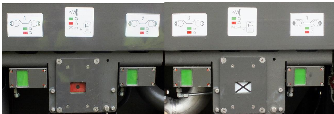
6. ábra Eltérő fék visszajelzések a mozdony két oldalán
