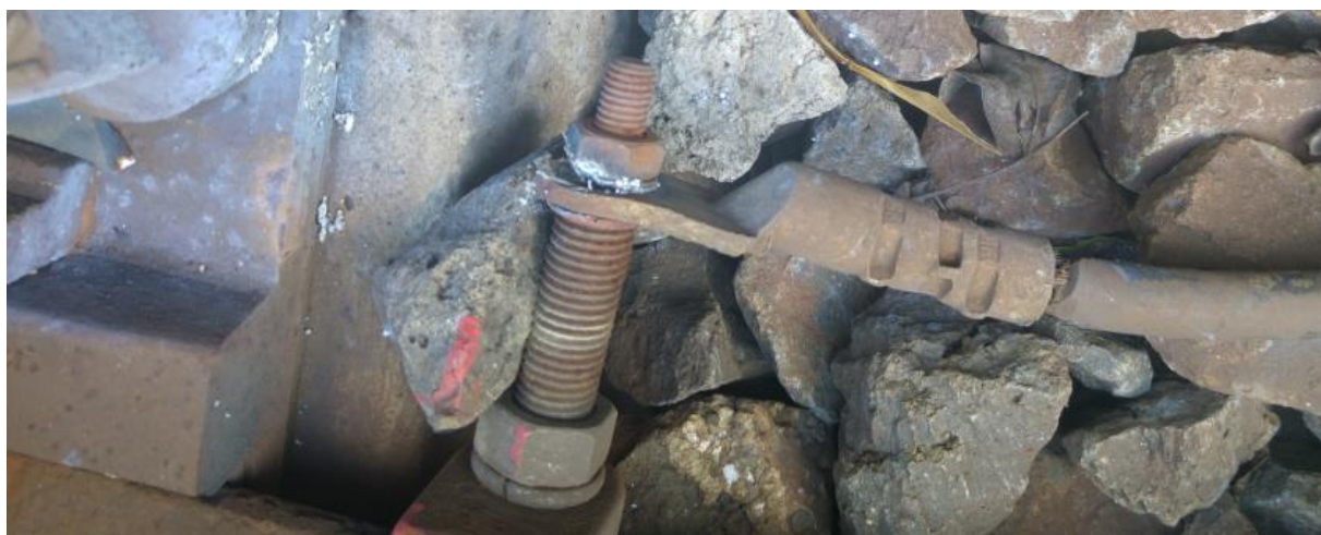
7. ábra: égési nyomok az üzemi földelésen
