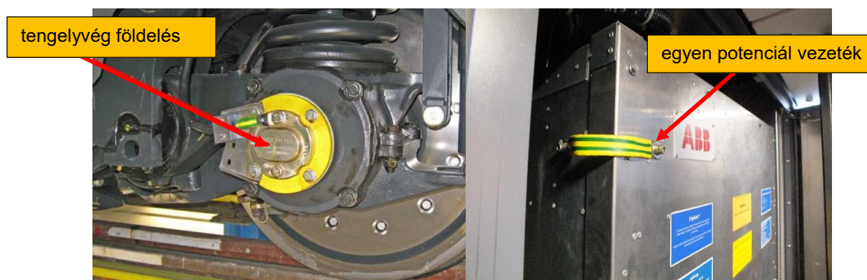
8. ábra: földelőkefe a kerékpártengelyvégen, vezetőállásról nyitható készülékszekrények
