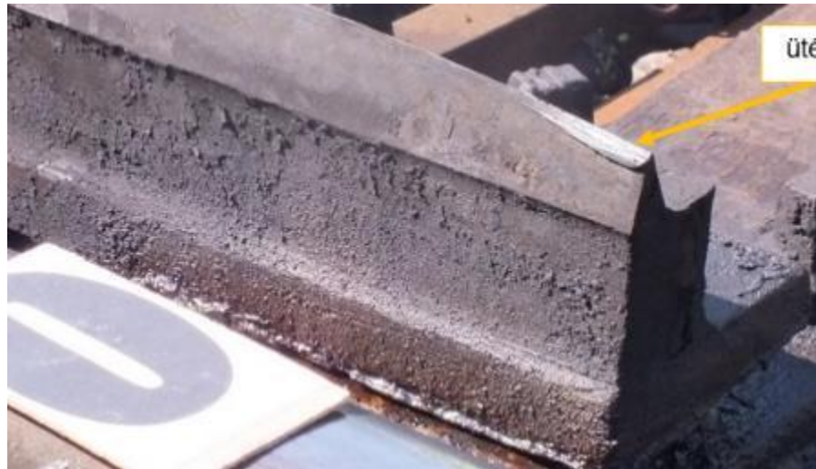
6. ábra: csúcssín hegyén az ütésnyom
