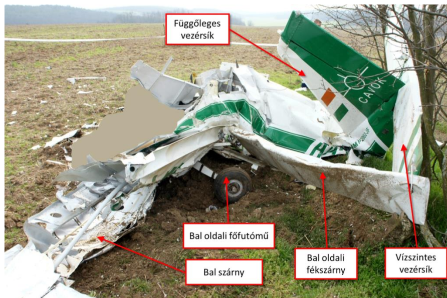
5. ábra: a sárkányszerkezet sérülései
