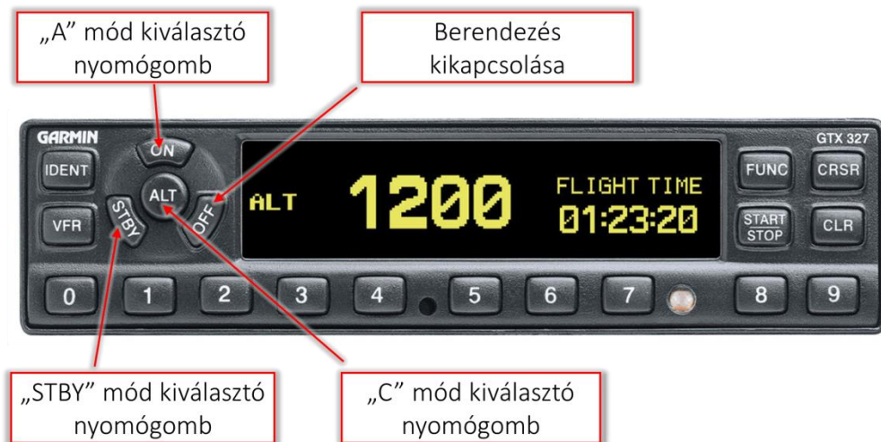
22. ábra: Garmin GTX327 transzponder kezelő felülete
