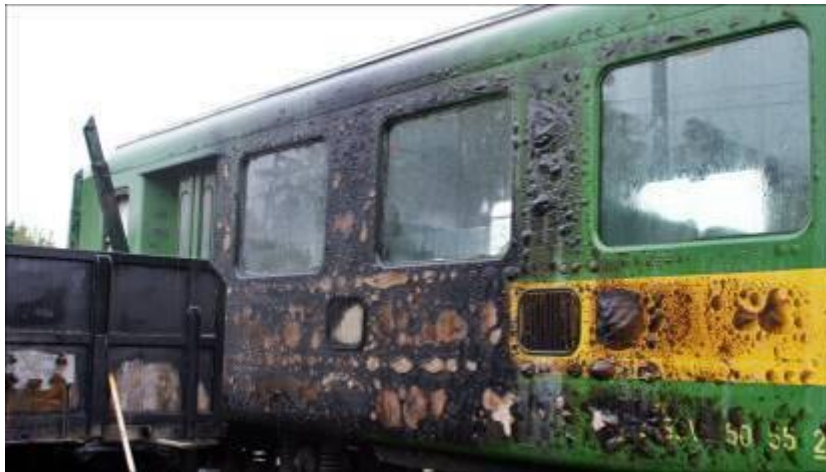
4.ábra: A keletkezett tűz nyoma a vonat utolsó személykocsiján
