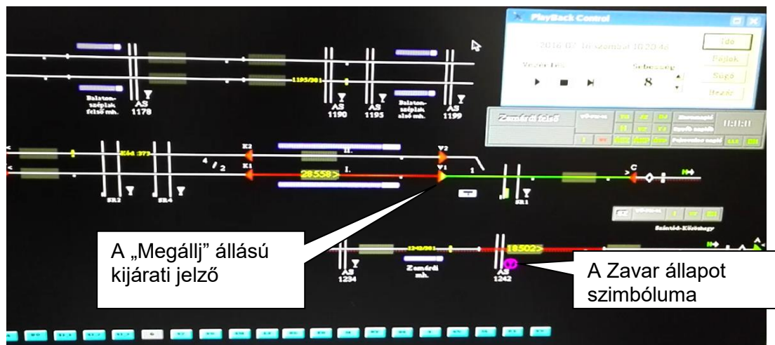
5. ábra: A biztosítóberendezés monitorképe az AS 1242 jelű útátjáró Zavar állapotának kezdetekor
