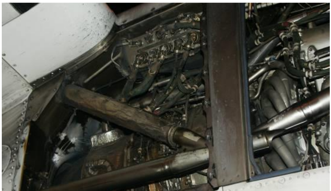
6. ábra Magas hőmérséklet látható jelei a №2 hajtómű gondolájában
