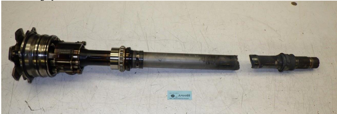
21. ábra munkaturbina megolvadt, és eltörött tengelye (Pratt & Whitney Canada)
