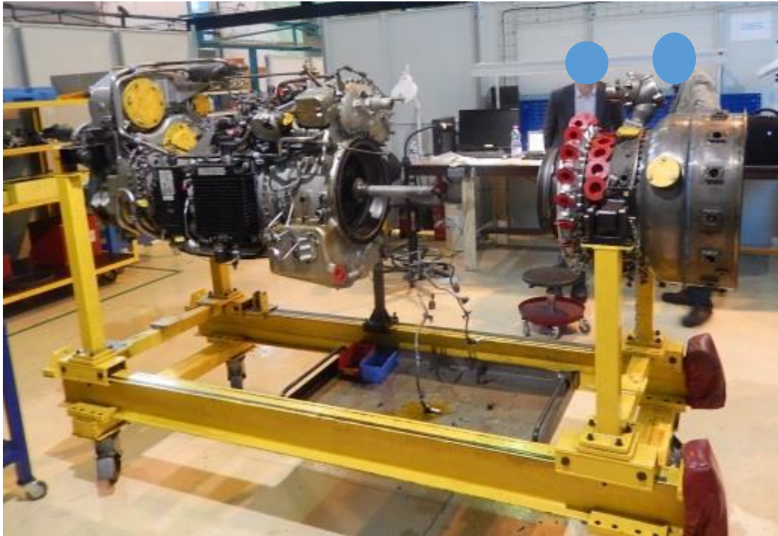
13. ábra A hajtómű szétszerelése a Vector Aerospace France párizsi üzemében
