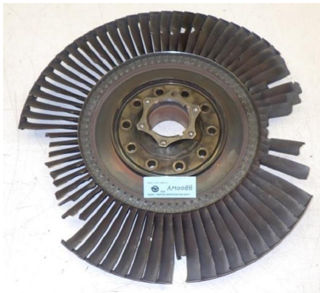
19-20. ábrák munkaturbina 2. fokozat forgórésze és törött, megolvadt tengelye (PWC)
