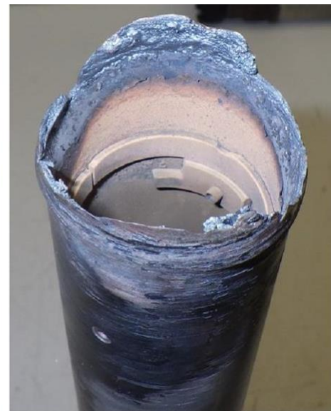
19-20. ábrák munkaturbina 2. fokozat forgórésze és törött, megolvadt tengelye (PWC)
