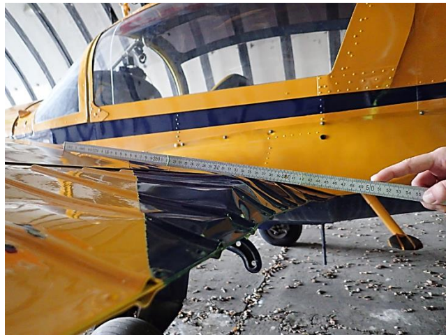
3. ábra: A fékszárny sérülése
