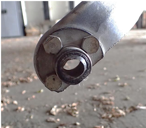
2. ábra: A törött tengely a futószár oldalán
