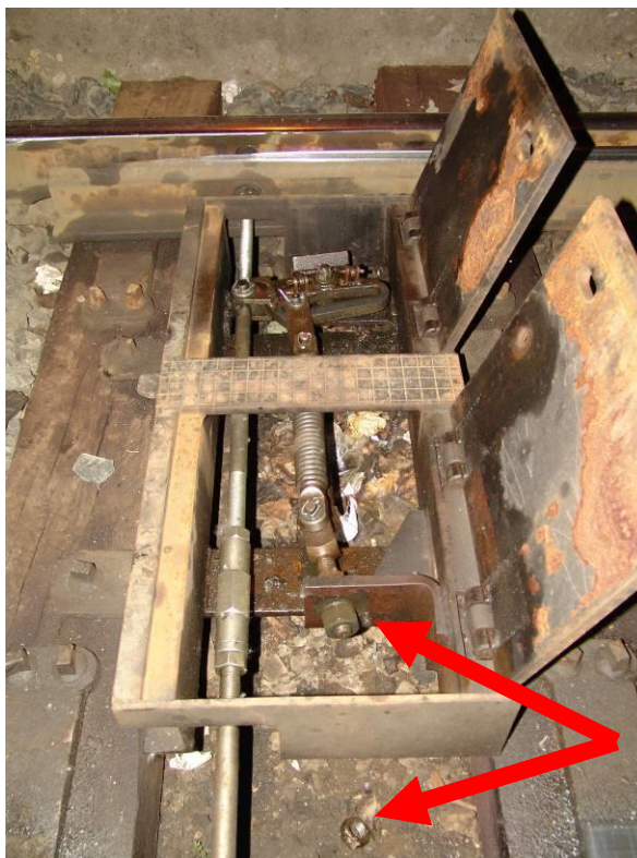
5. ábra: A letekeredett és lelazult csavarok
