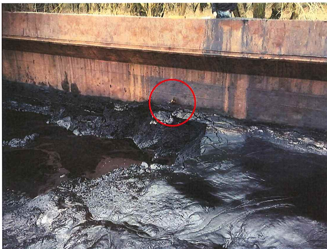
8. ábra: A raktér átszakított lemezelése
