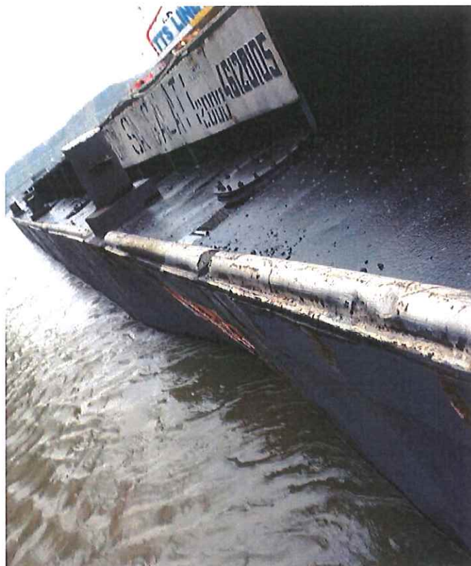
7. ábra: A bárka benyomott oldala
