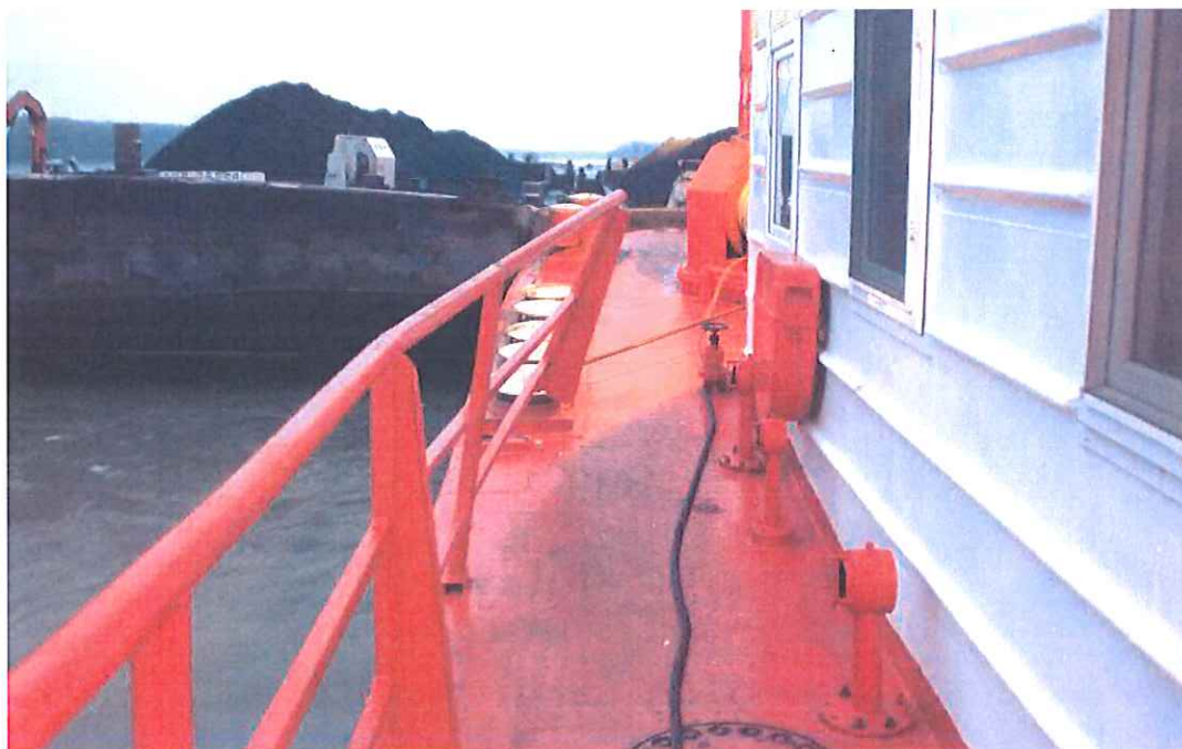
10. ábra: A felszakadt és meghajlott korlát a Mercur 304 tolóhajó bal oldalán
