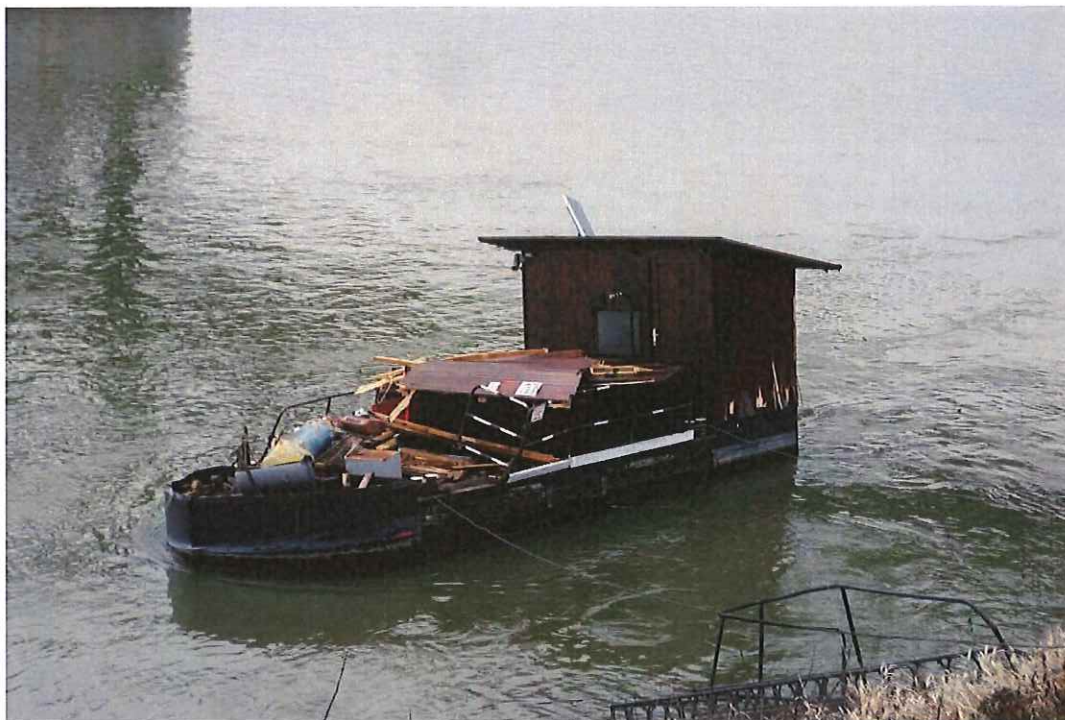
11. ábra: Az U-10375-30 felépítményes haltároló úszómű a sérült felépítménnyel
