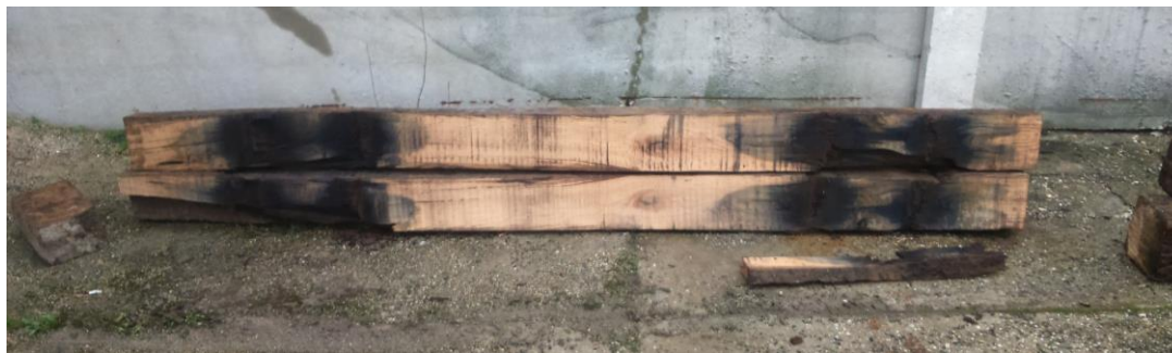
5. ábra: a kisiklás helyén kibontott és kettévágott alj (fotó: GySEV Zrt.)
