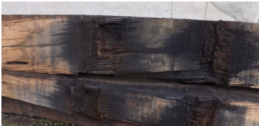
10. ábra: csavarfuratok a kibontott aljon (fotó: GySEV Zrt.)
