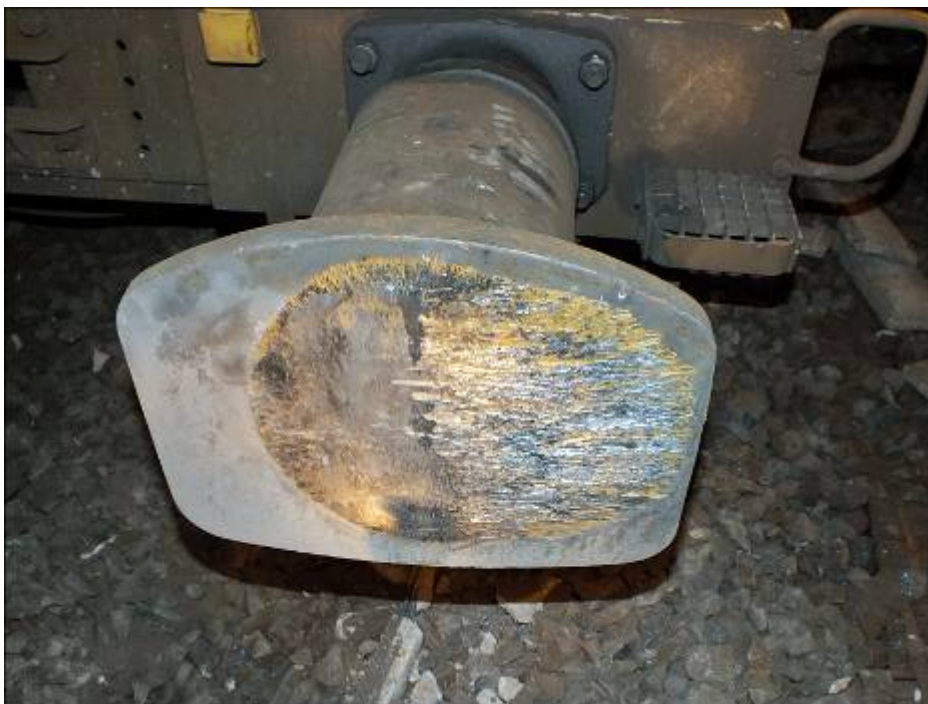
8. ábra: Kenetlen rugótányér, csorodásokkal az egyik siklott járművön
