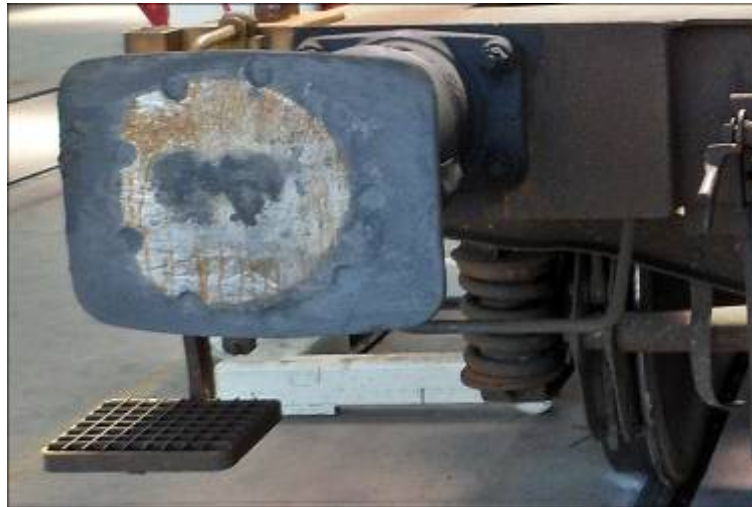
5. ábra: Kenetlen ütközőtányér a telephelyen
