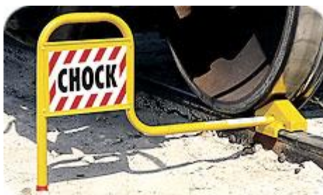
10. ábra: távolról észlelhető rögzítősaru (forrás: www.rail-chocks.com )
