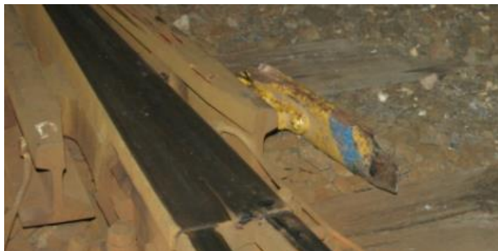
9. ábra: az érintett rögzítősaru az eseményt követően
