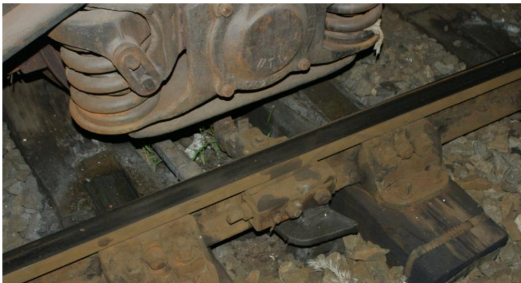
6. ábra: A jármű kereke a váltó rudazatán
