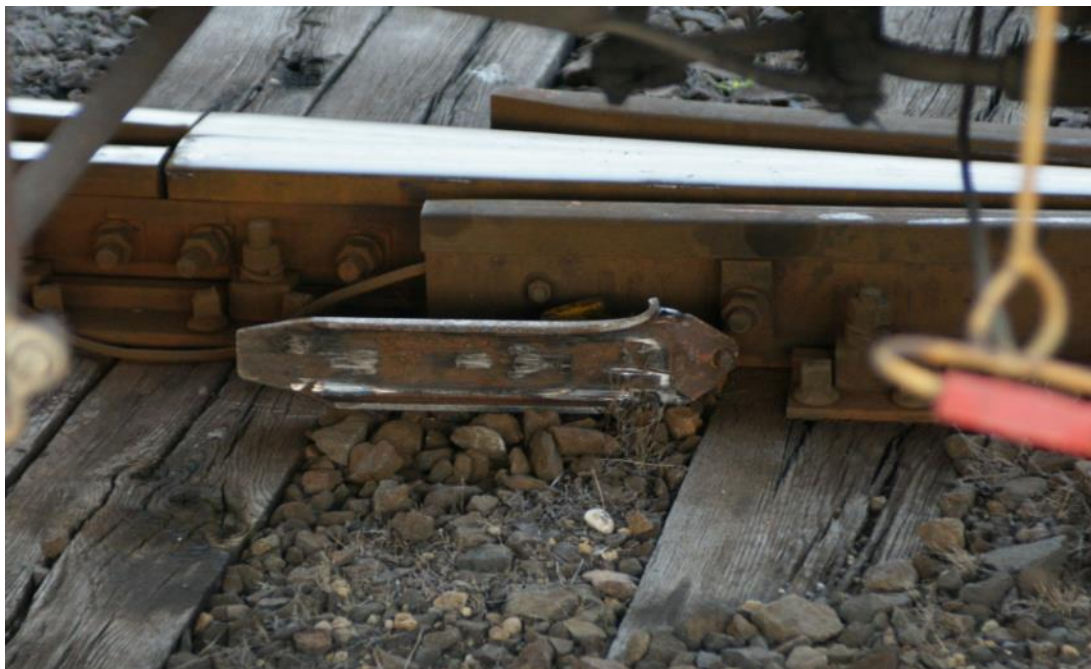
3. ábra A helyszínen talált rögzítősaru.
