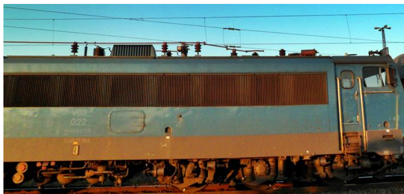
3. ábra: A letört áramszedőjű mozdony
