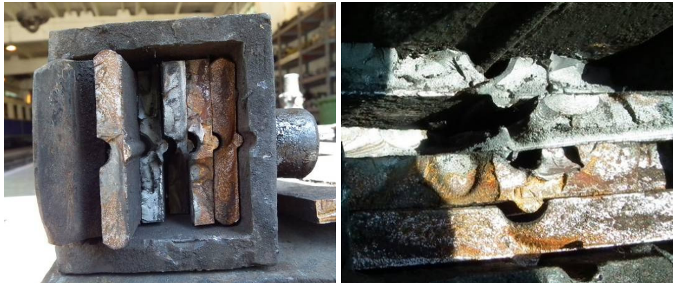
4. ábra: az eltört laprugó és törési felületei
