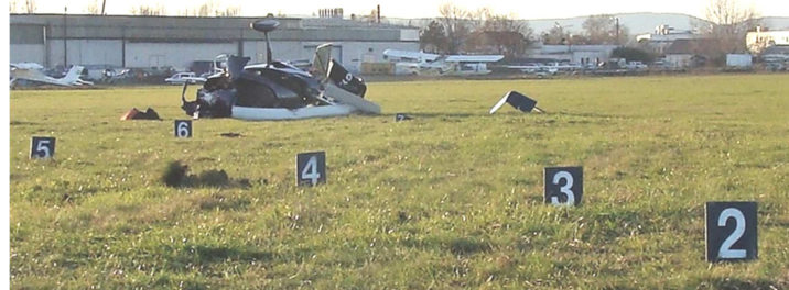
A forgószárny lapátok nyomai és a roncs helyzete
