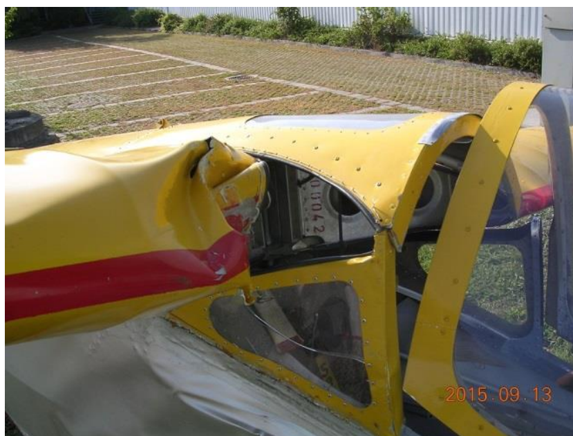
8. ábra: a jobb oldali szárnytő belépőélen a lámpaoszloppal ütközés nyoma
