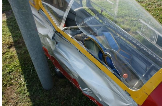
5. ábra: a kabintető sérülései
