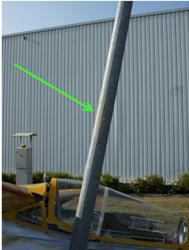
9. ábra: festéknyomok a lámpaoszlopon
