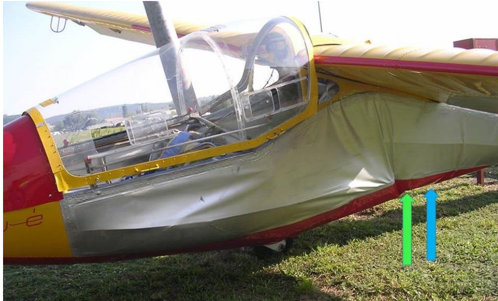
7. ábra: a repülőgép szegélyfallyal történő ütközésének nyoma
