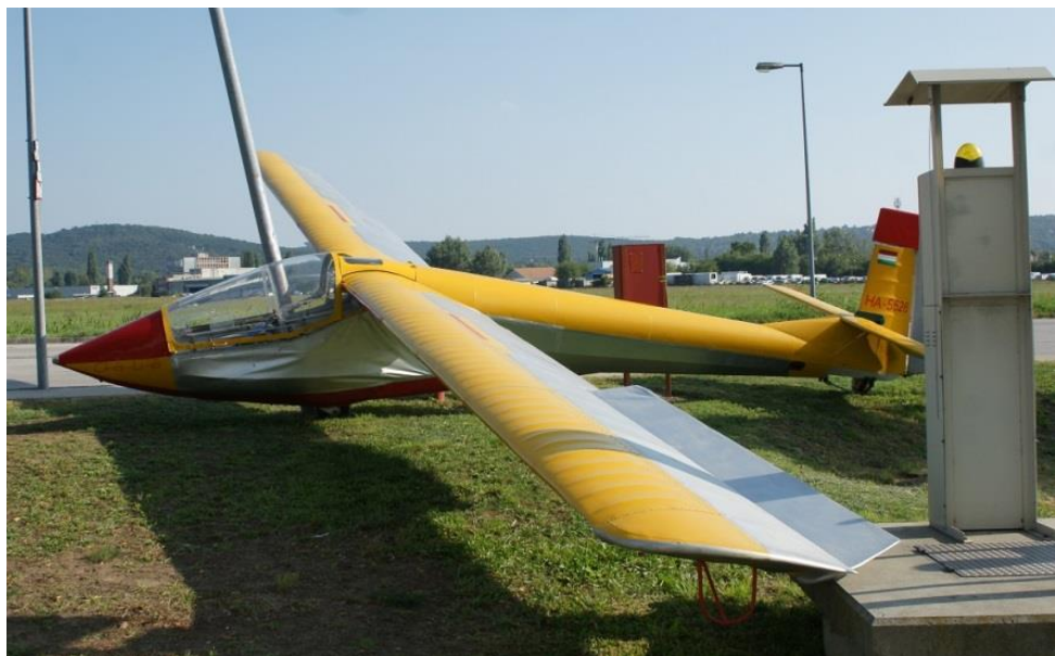
10. ábra: a sérülésmentes elektromos elosztószekrény és ép bal csűrő kilépő
