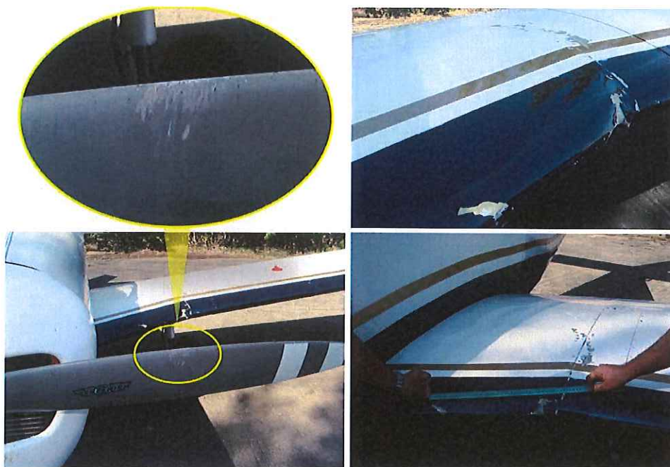
5. ábra: a légszavar és a szárny belépőél sérülései
