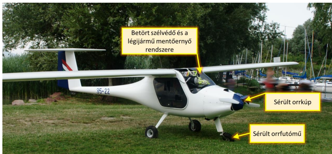
3. ábra: légijármű sérülései a vízből kiemelés után a balatonberényi strandon
