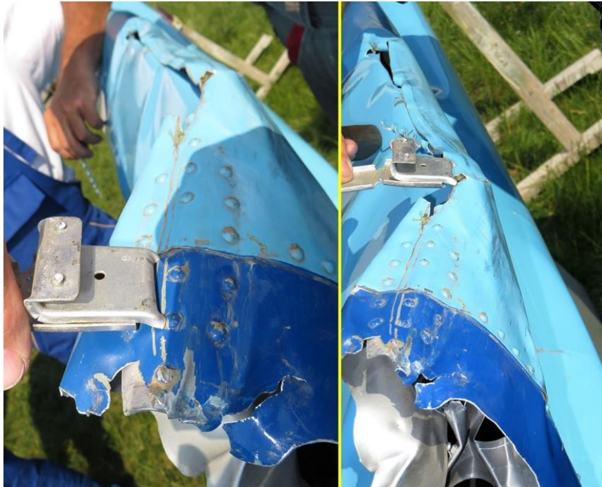
11. ábra Sérülés azonosítása a Légijármű-1 szárny belépőél mentén a Légijármű-2-ből kiépített hosszmerítő tartóbak segítségével
