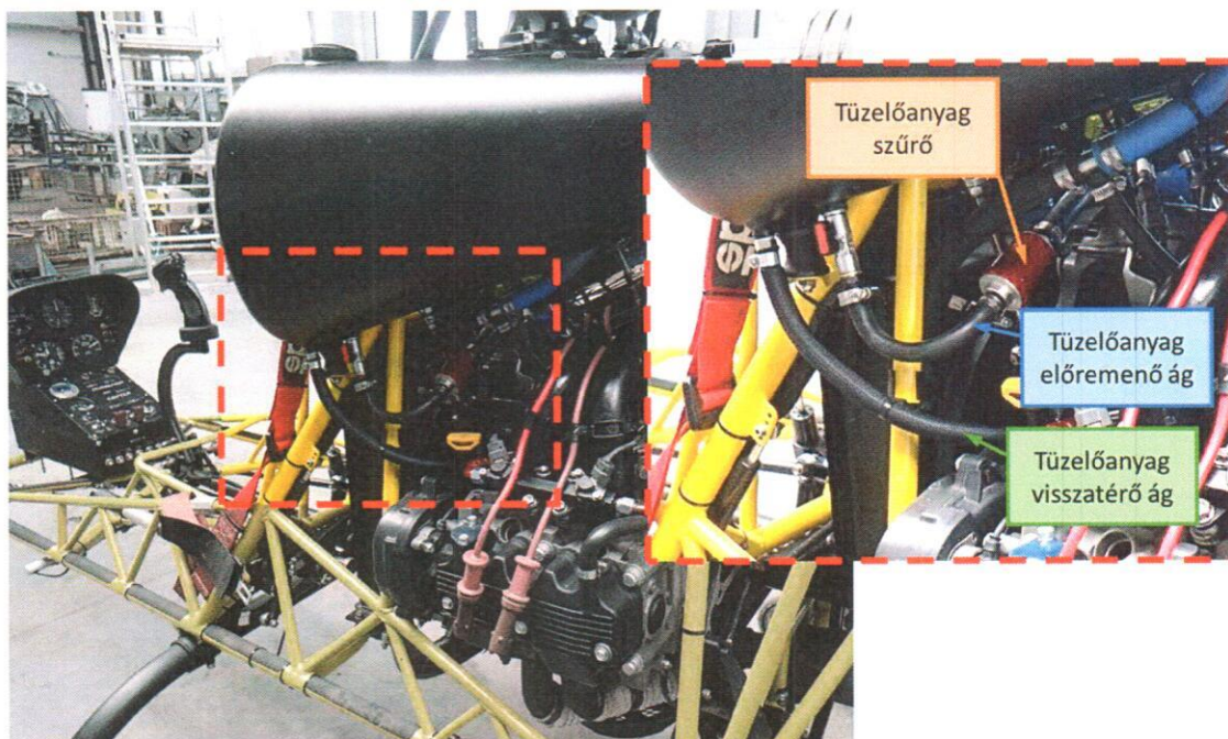
9. ábra: a tüzelőanyag tartály vezetékei az újjáépített helikopteren
