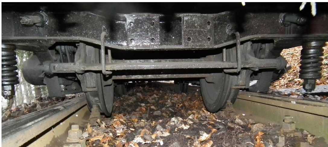
4. ábra: a személykocsi kisiklott forgóváza
