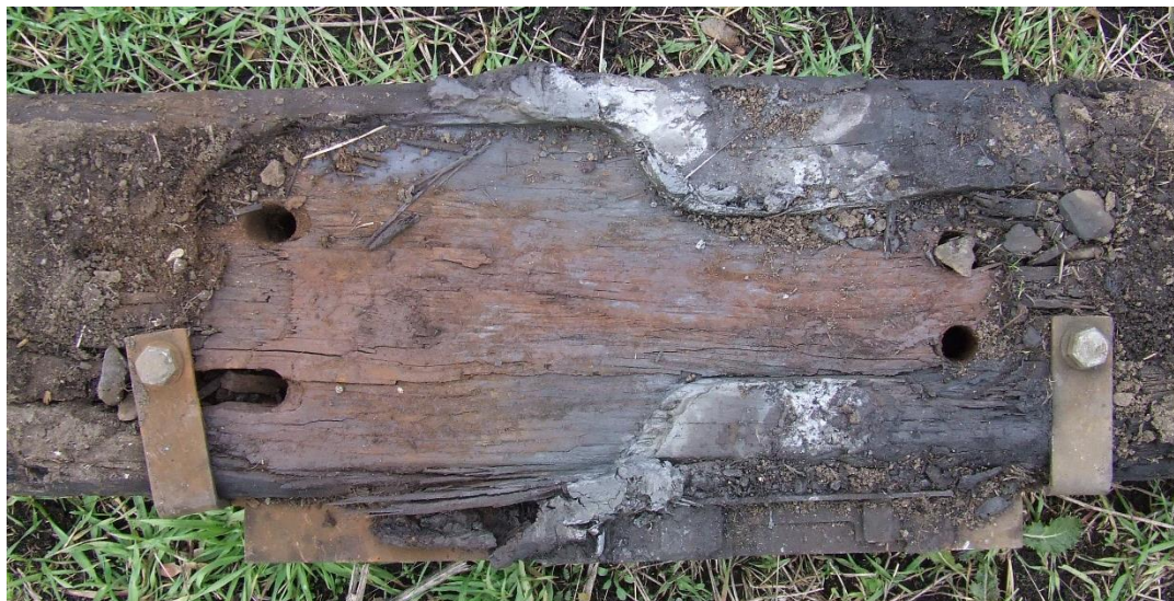
8. ábra: ovális és szennyeződéssel teli furatok
