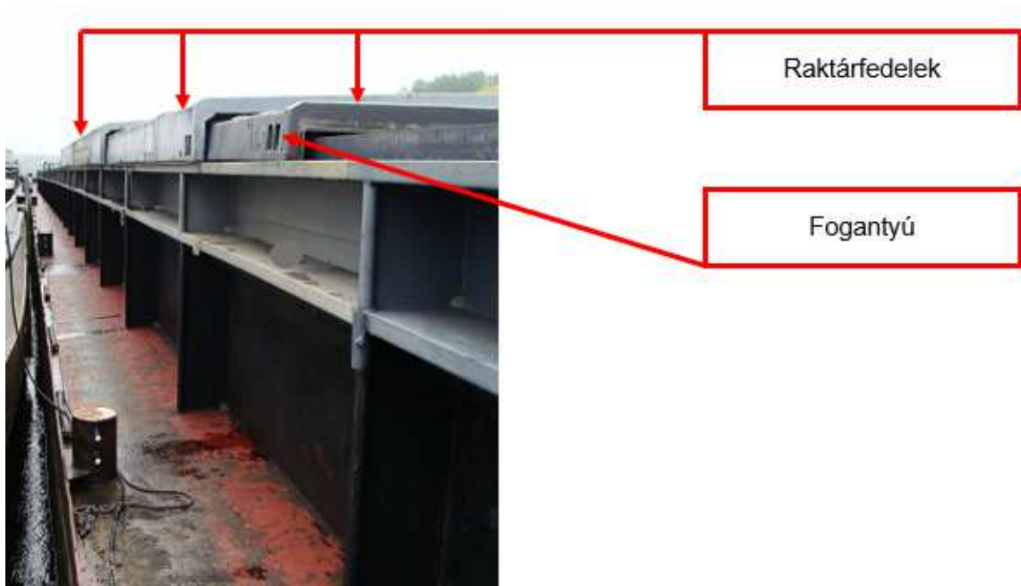
5. ábra: a „Wanja” önjáró görgős raktárfedelei
